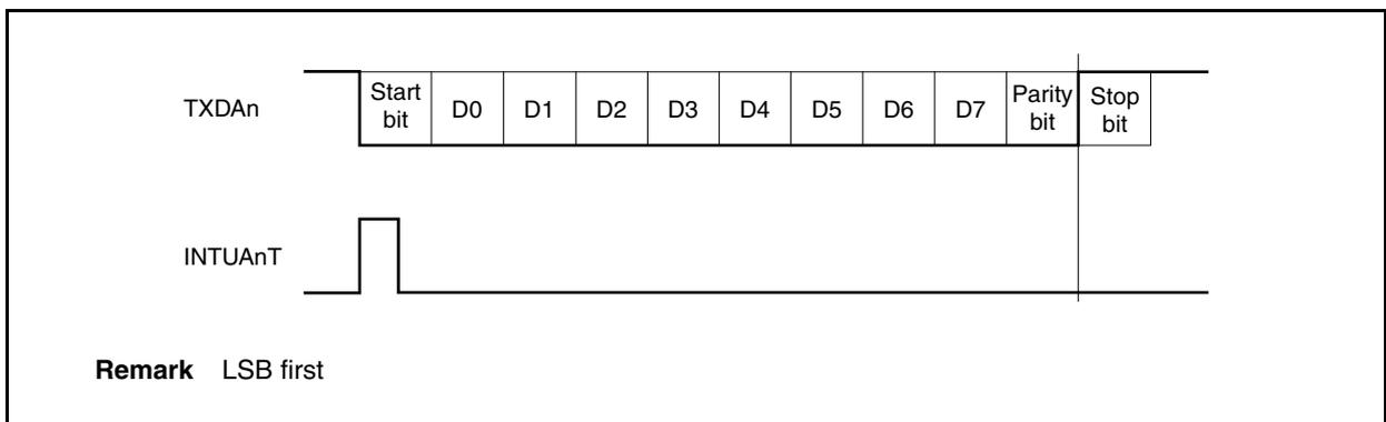
**Figure 15-8. UART Transmission Flow**
