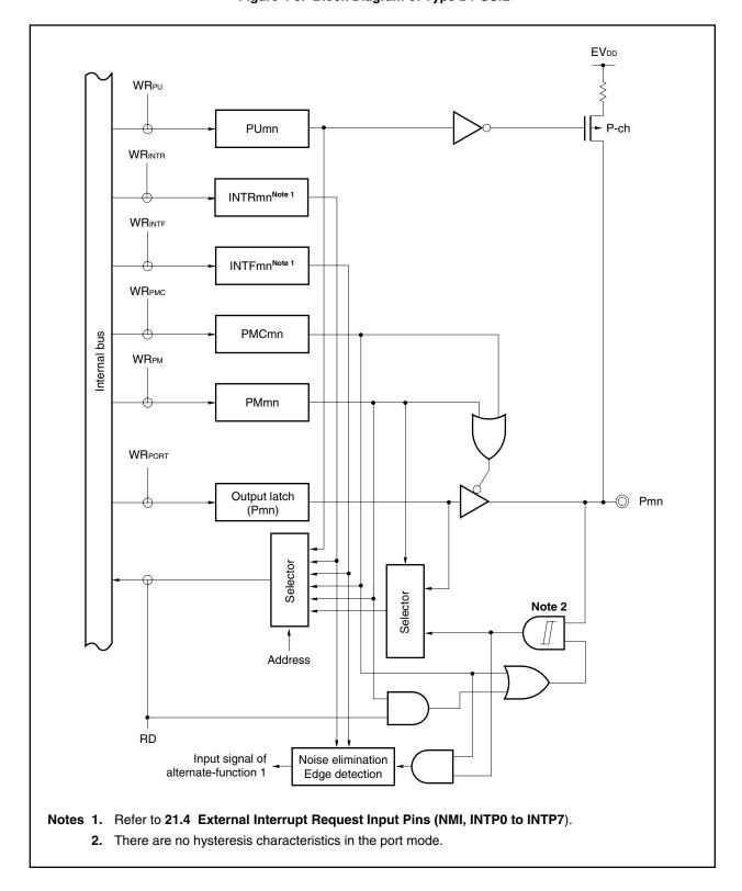
Figure 4-9. Block Diagram of Type D1-SUIL
