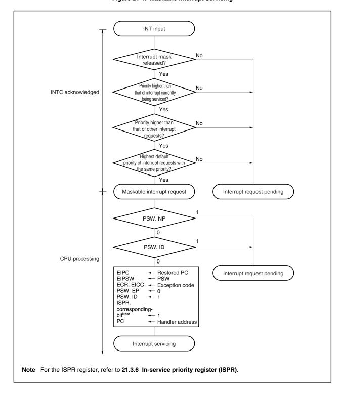
Figure 21-4. Maskable Interrupt Servicing
