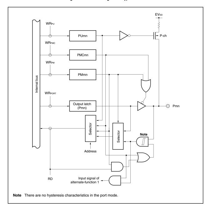
Figure 4-10. Block Diagram of Type D1-SUL
