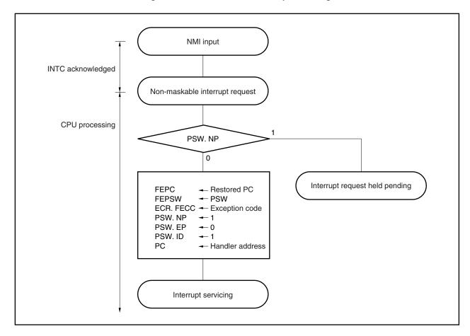
Figure 21-2. Non-Maskable Interrupt Servicing
