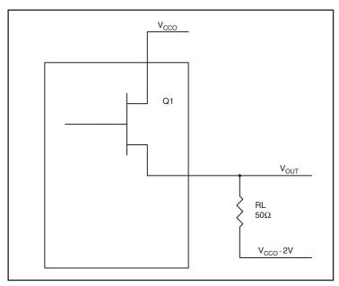
FIGURE 6. LVPECL DRIVER CIRCUIT AND TERMINATION
