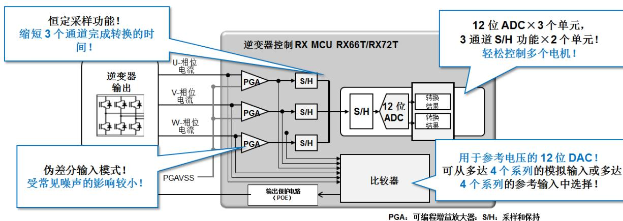
图 10: RX66T/RX72T 系列配备的 A/D 转换器的特性
