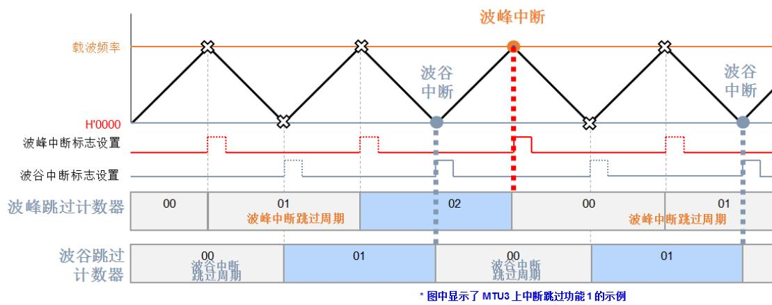
图 4：三相互补 PWM 定时器的中断细化功能
