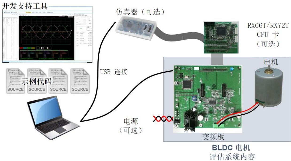
图 12: BLDC 电机评估系统的配置
