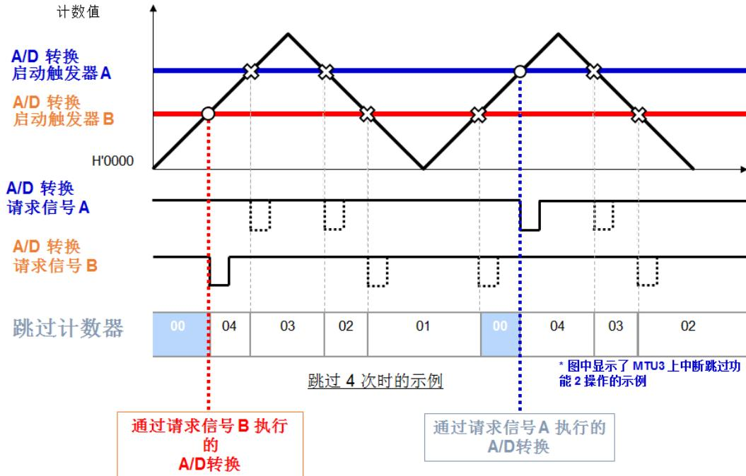
图 5: 三相互补 PWM 定时器的 A/D 转换细化功能
