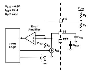
Figure 27. Soft-Start Circuit
