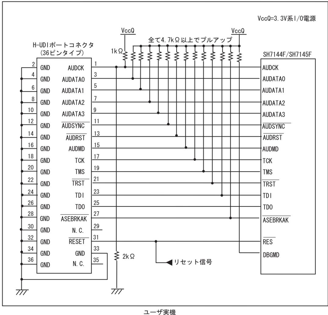
図 1.4 E10A-USB 使用時の H-UDI ポートコネクタ - チップ間の接続例
