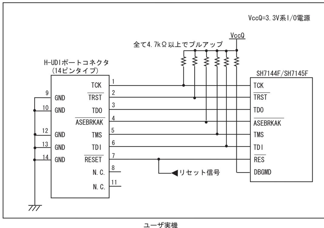
図 1.6 E10A-USB 使用時の H-UDI ポートコネクタ - チップ間の接続例
