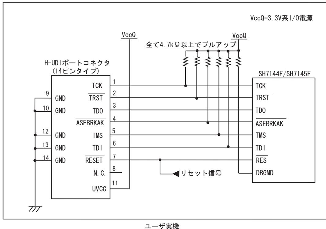
図 1.5 E10A-USB 使用時の H-UDI ポートコネクタ - チップ間の推奨接続例 (14ピンタイプ UVCC 接続時)
