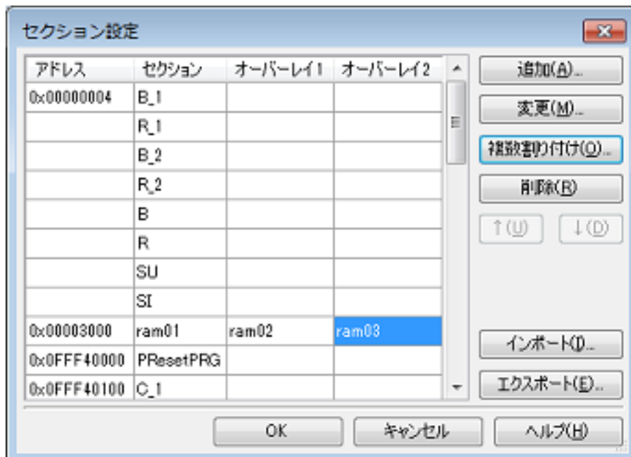
図 2.50 セクション設定 ダイアログ (オーバーレイ・セクション追加後)
