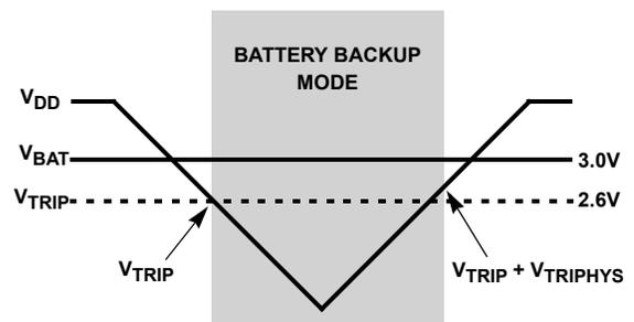
FIGURE 8. BATTERY SWITCHOVER WHEN V<sub>BAT</sub> > V<sub>TRIP</sub>
