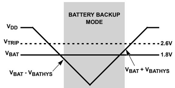
FIGURE 7. BATTERY SWITCHOVER WHEN V<sub>BAT</sub> < V<sub>TRIP</sub>
