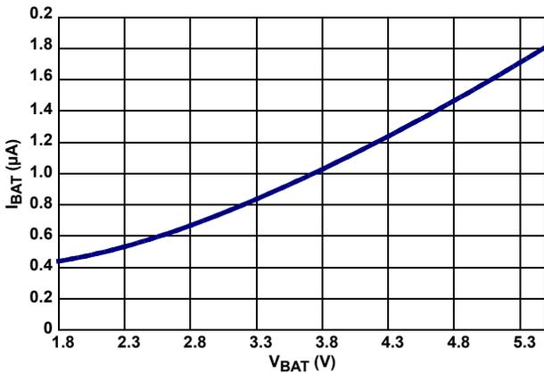
FIGURE 1. I<sub>BAT</sub> vs V<sub>BAT</sub>
