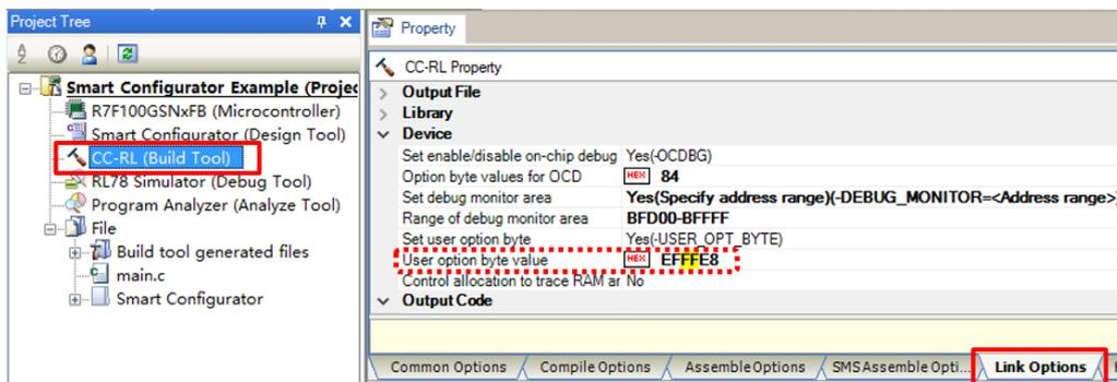
**Figure 3-2. Option Byte C1H Value in CS+**
