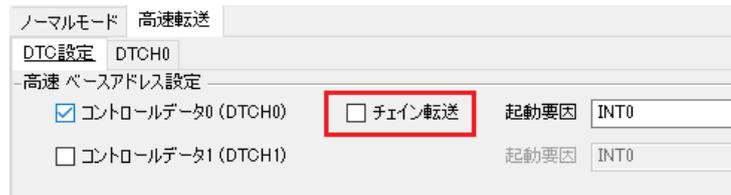
図 6-2 高速 DTC のチェーン転送
