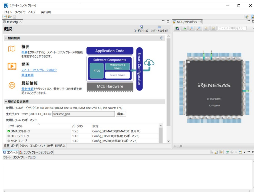
図 5-5 スマート・コンフィグレータの起動
