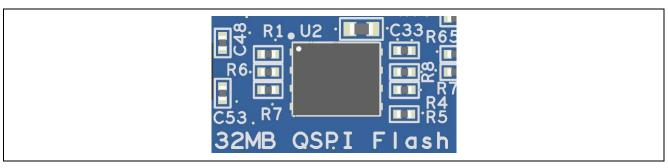
Figure 24. Quad-SPI Flash
