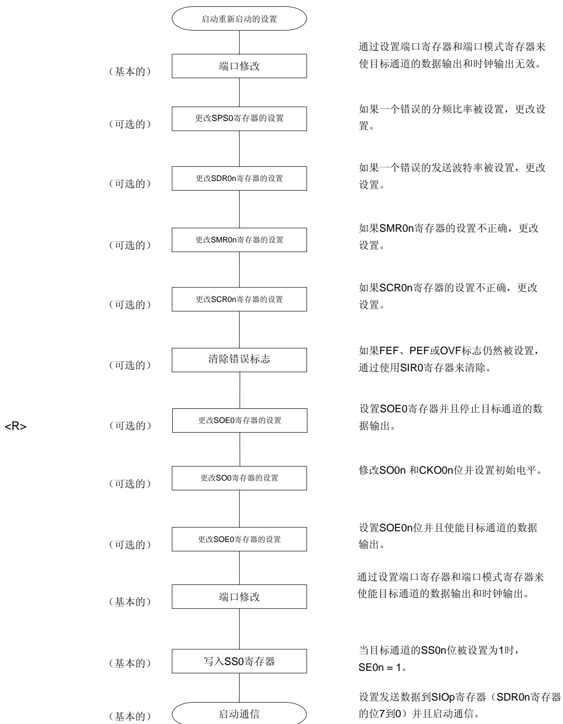
图 11-27. 重新启动主发送的过程
