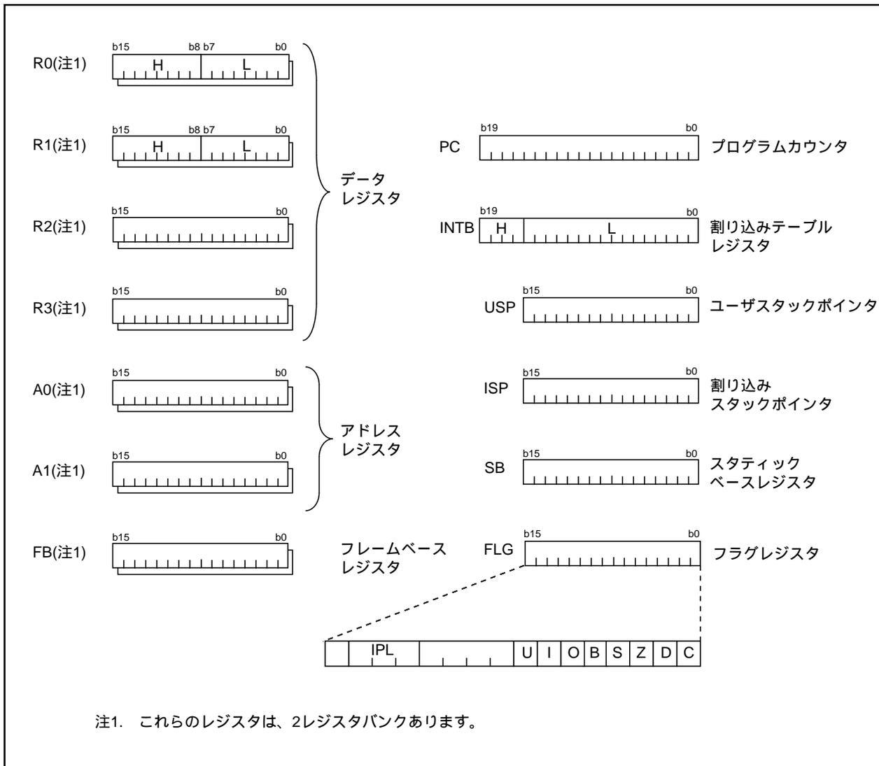
図1.4.1. 中央演算処理装置のレジスタ構成
