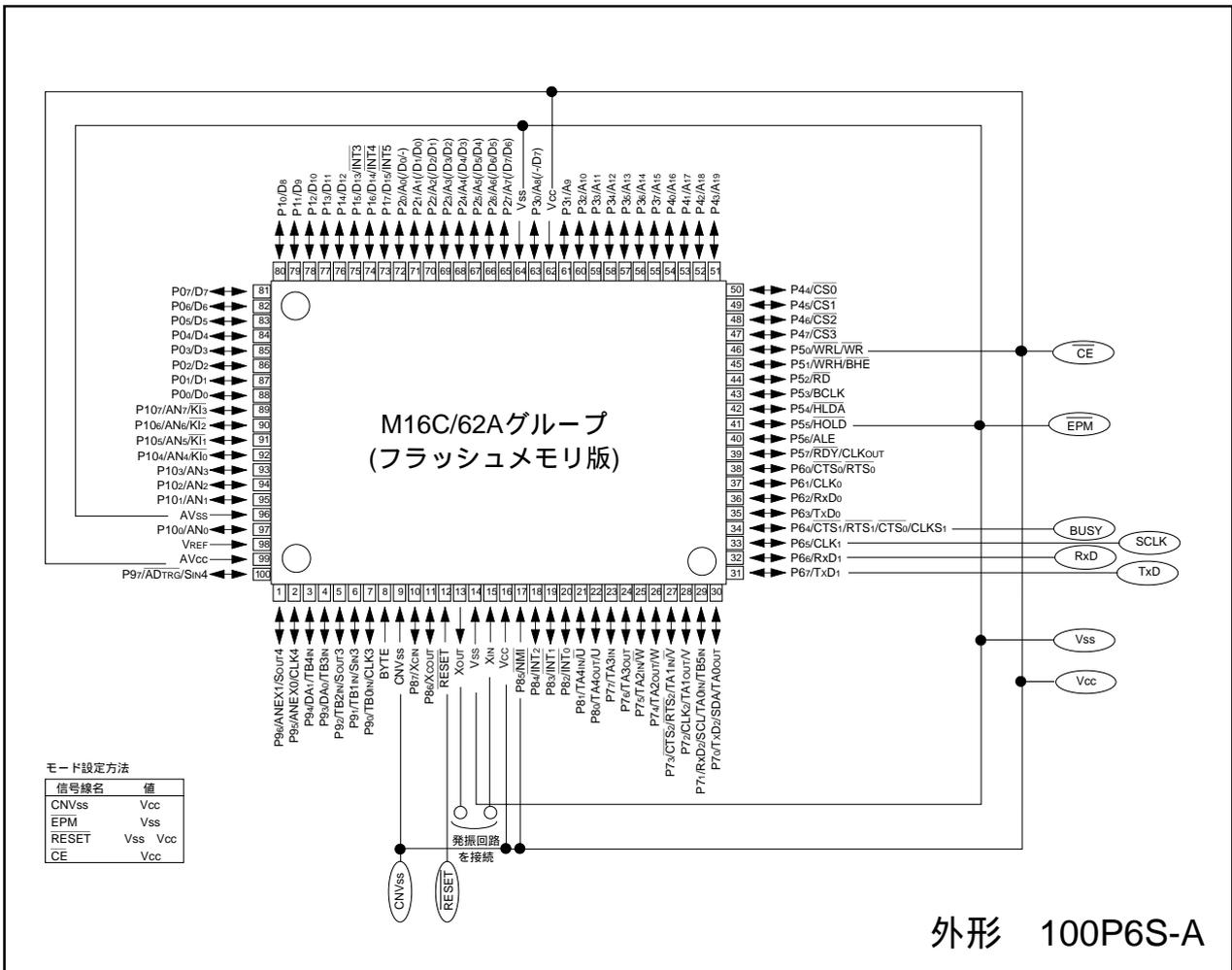
図1.29.1. 標準シリアル入出力モード時の端子結線図(1)
