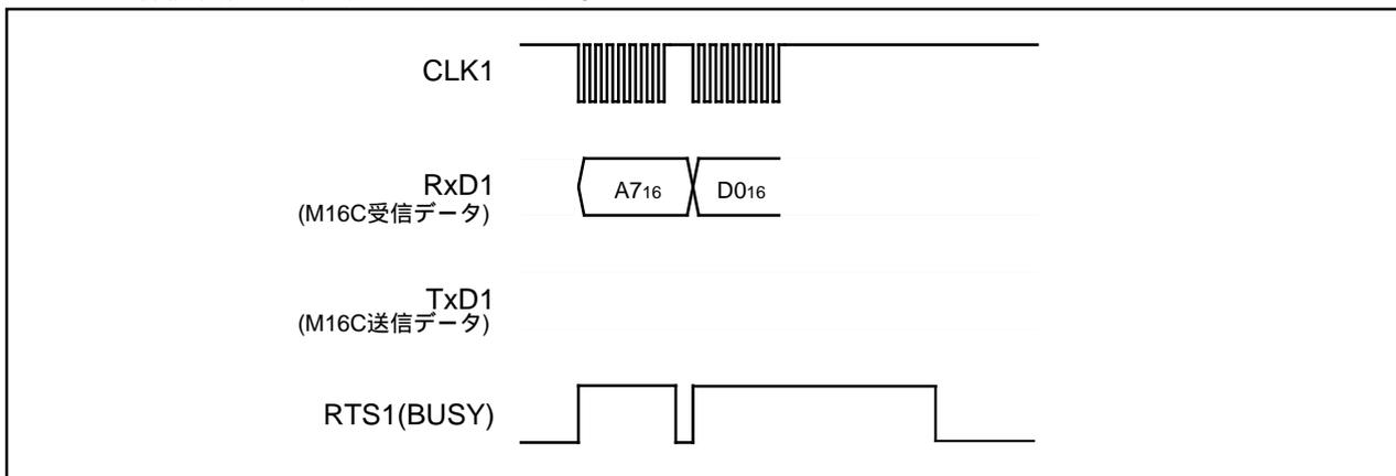
図1.29.8. イレーズ全アンロックブロックコマンド時のタイミング
