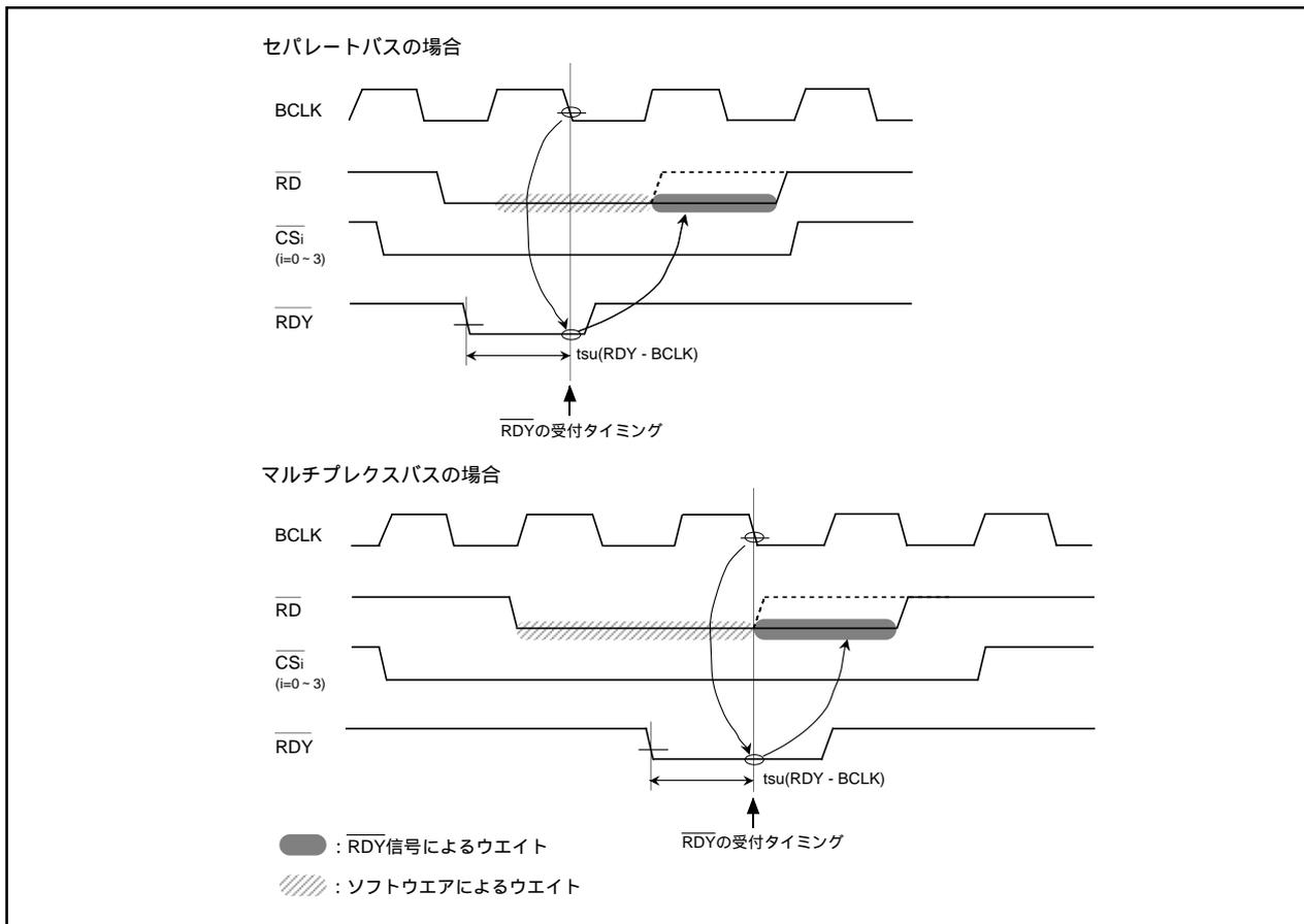
図1.9.4. RD信号が $\overline{\text{RDY}}$ 信号によつてのびた例
