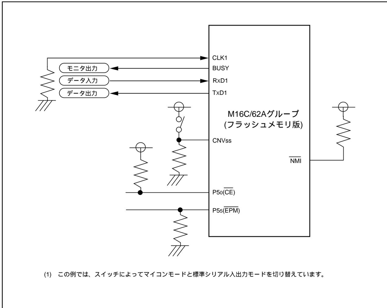
図1.29.43. 標準シリアル入出力モード2時の応用回路例
