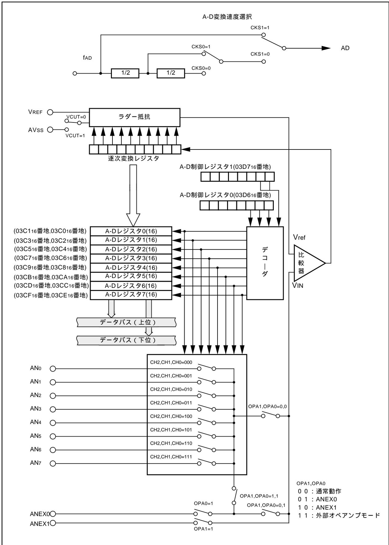
図1.17.1. A-D変換器のブロック図
