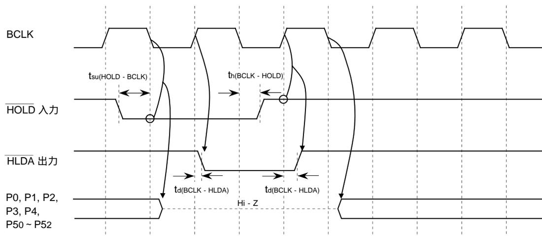
注1. BYTE端子の入力レベル、プロセッサモードレジスタ0のポートP4<sub>0</sub> ~ P4<sub>3</sub>機能選択ビット(PM06)にかかわらず上記ピンはすべてハイインピーダンス状態になります。
