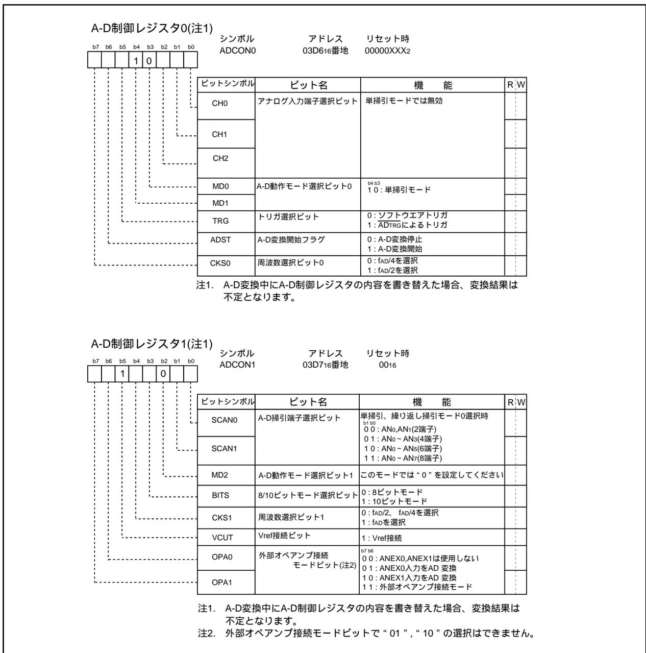
図1.17.6. 単掃引モード時のA-D制御レジスタ
