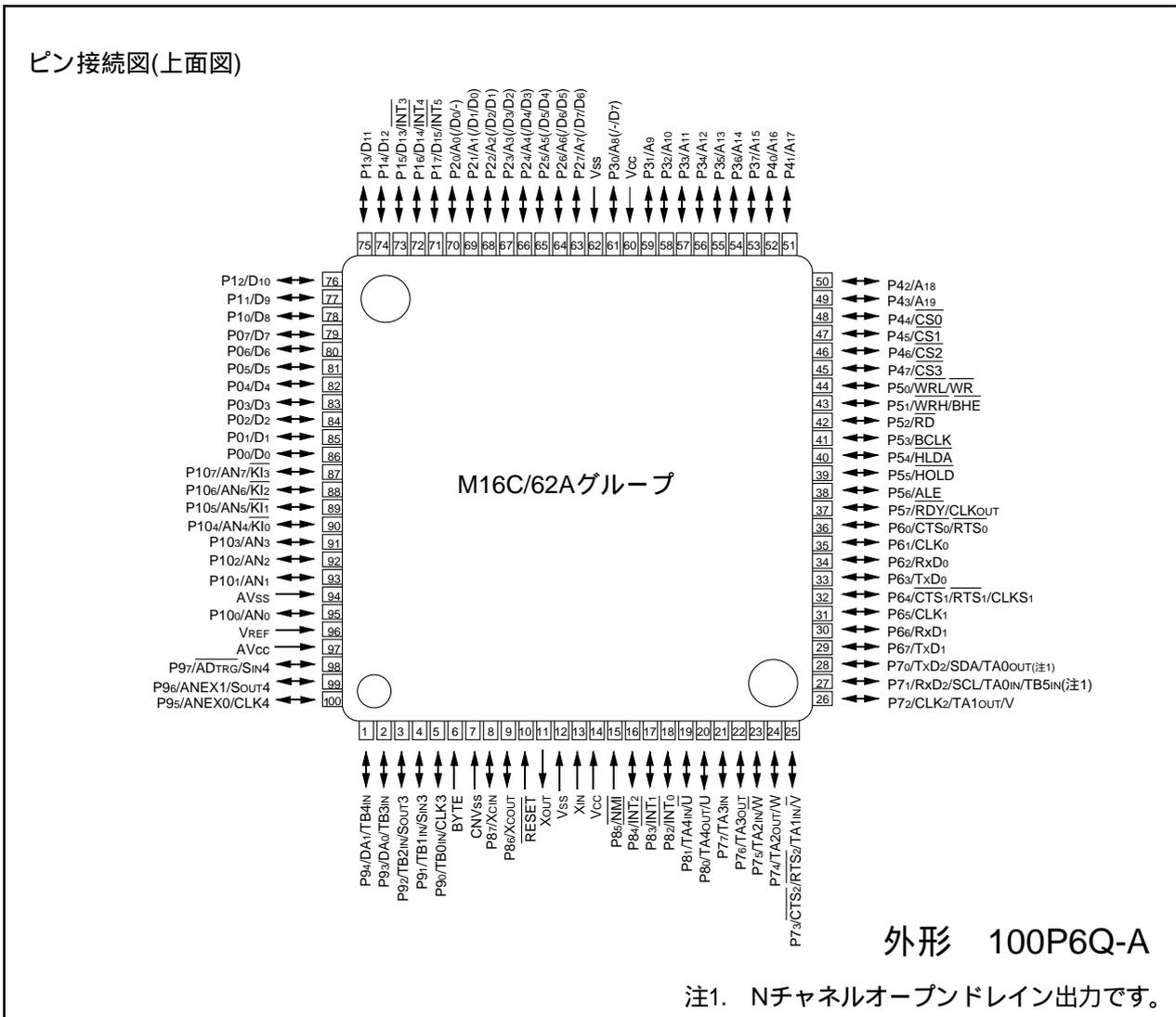
図1.1.2. ピン接続図(上面図)
