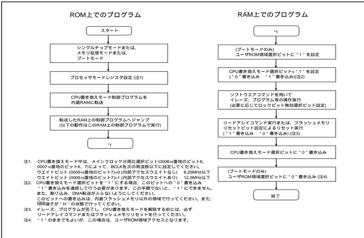
図1.26.2. CPU書き換えモードの設定/解除フローチャート
