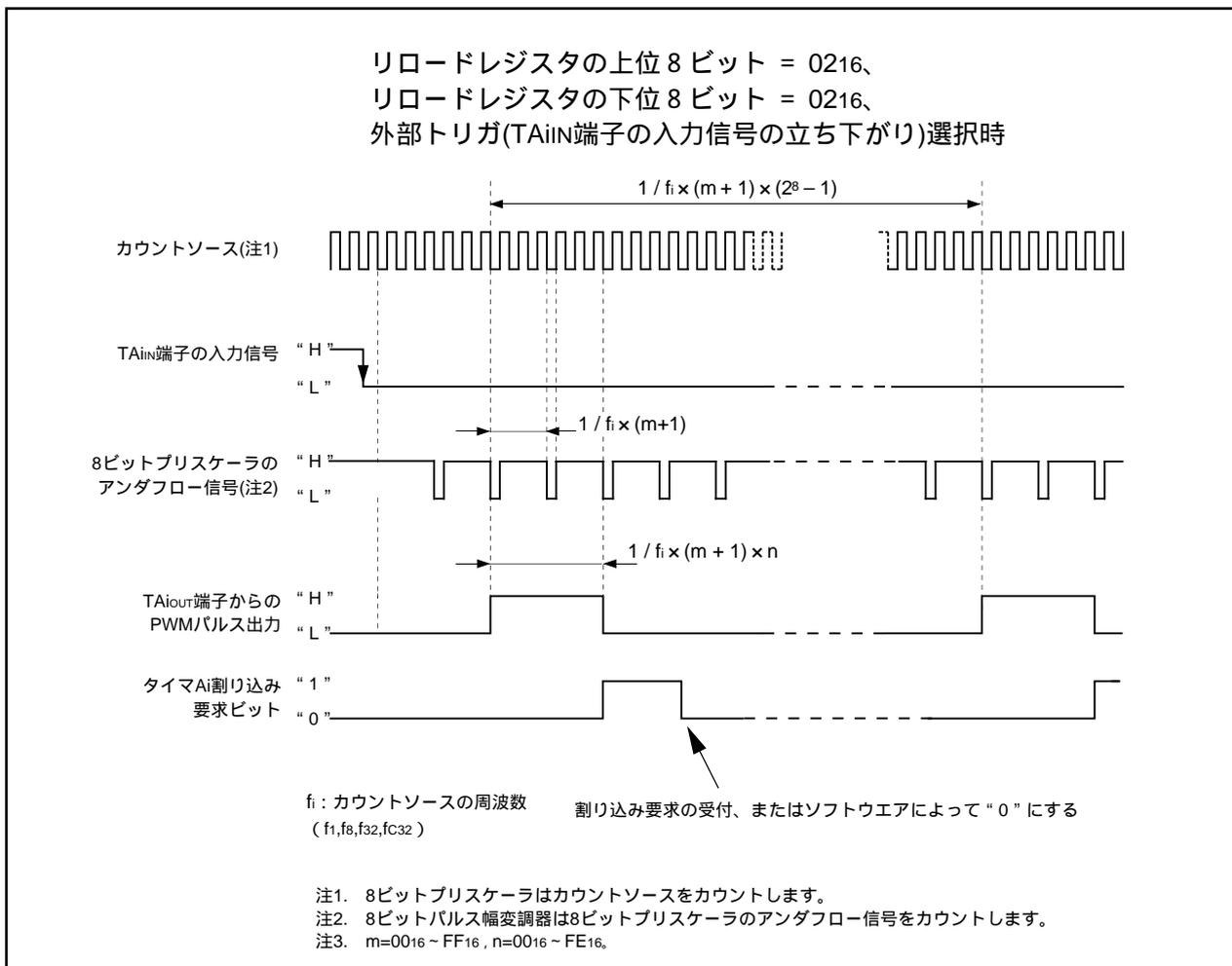
図1.14.13. 8ビットパルス幅変調器の動作例
