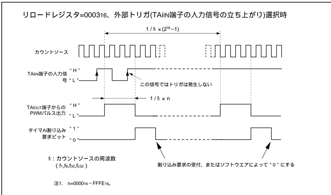
図1.14.12. 16ビットパルス幅変調器の動作例
