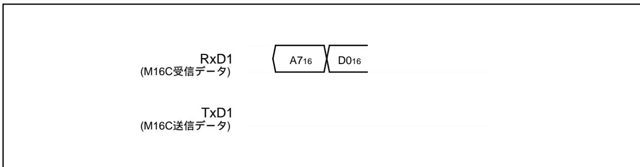
図1.29.28. イレーズ全アンロックブロックコマンド時のタイミング
