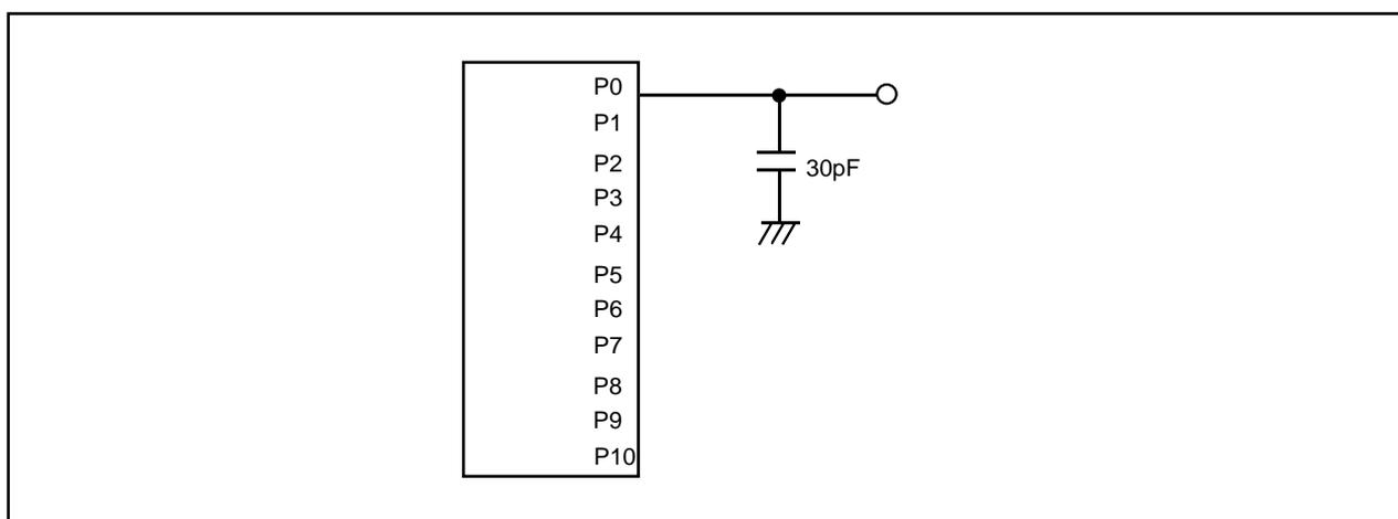
図1.23.1. ポートP0 ~ P10の測定回路
