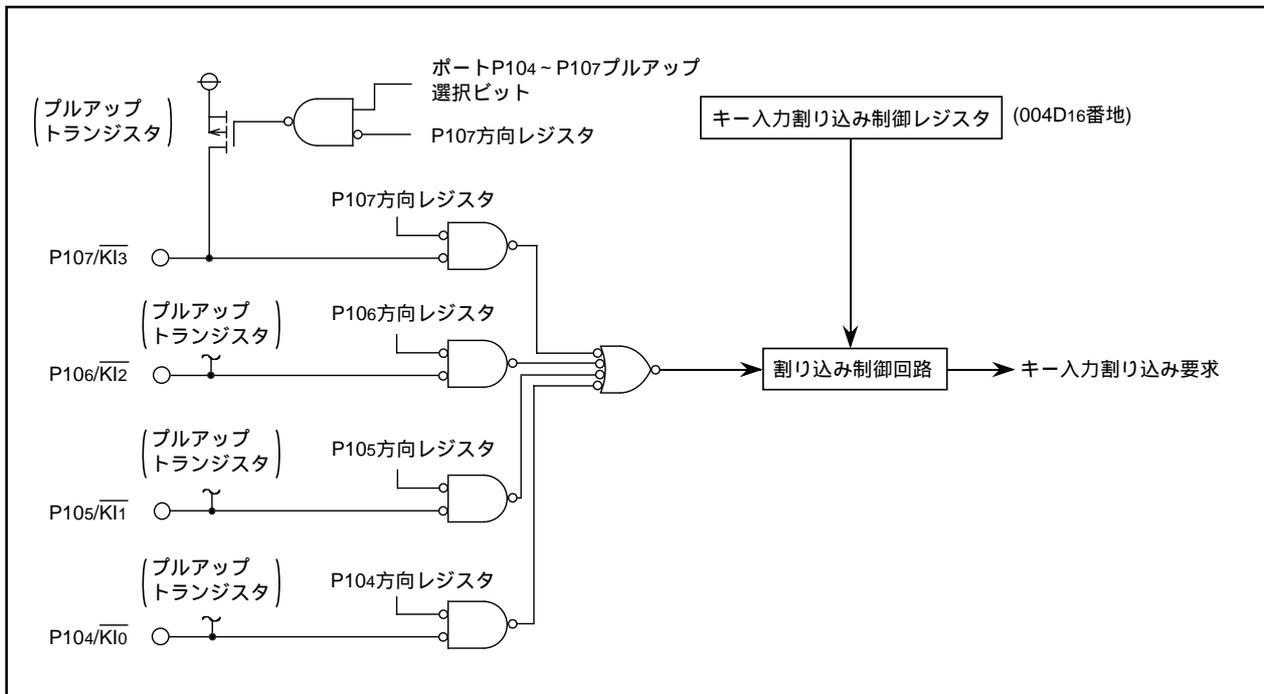
図1.11.11. キー入力割り込みのブロック図
