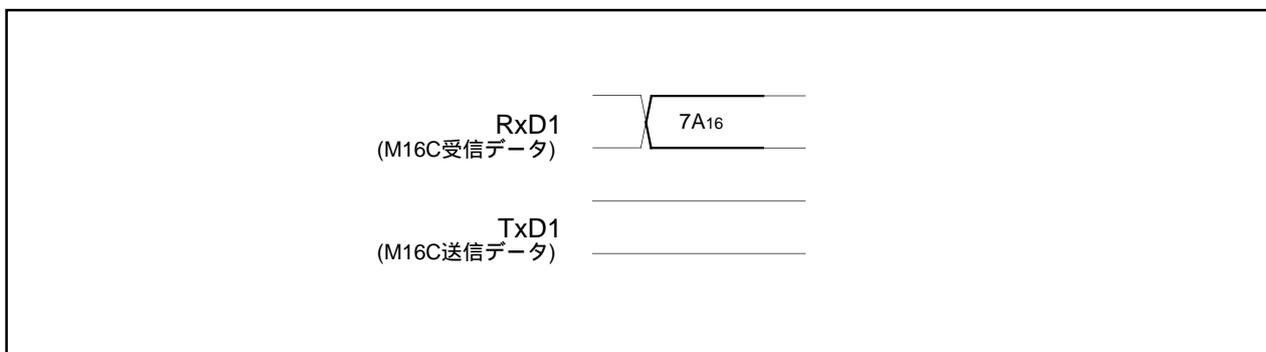
図1.29.31. ロックビット有効コマンド時のタイミング
