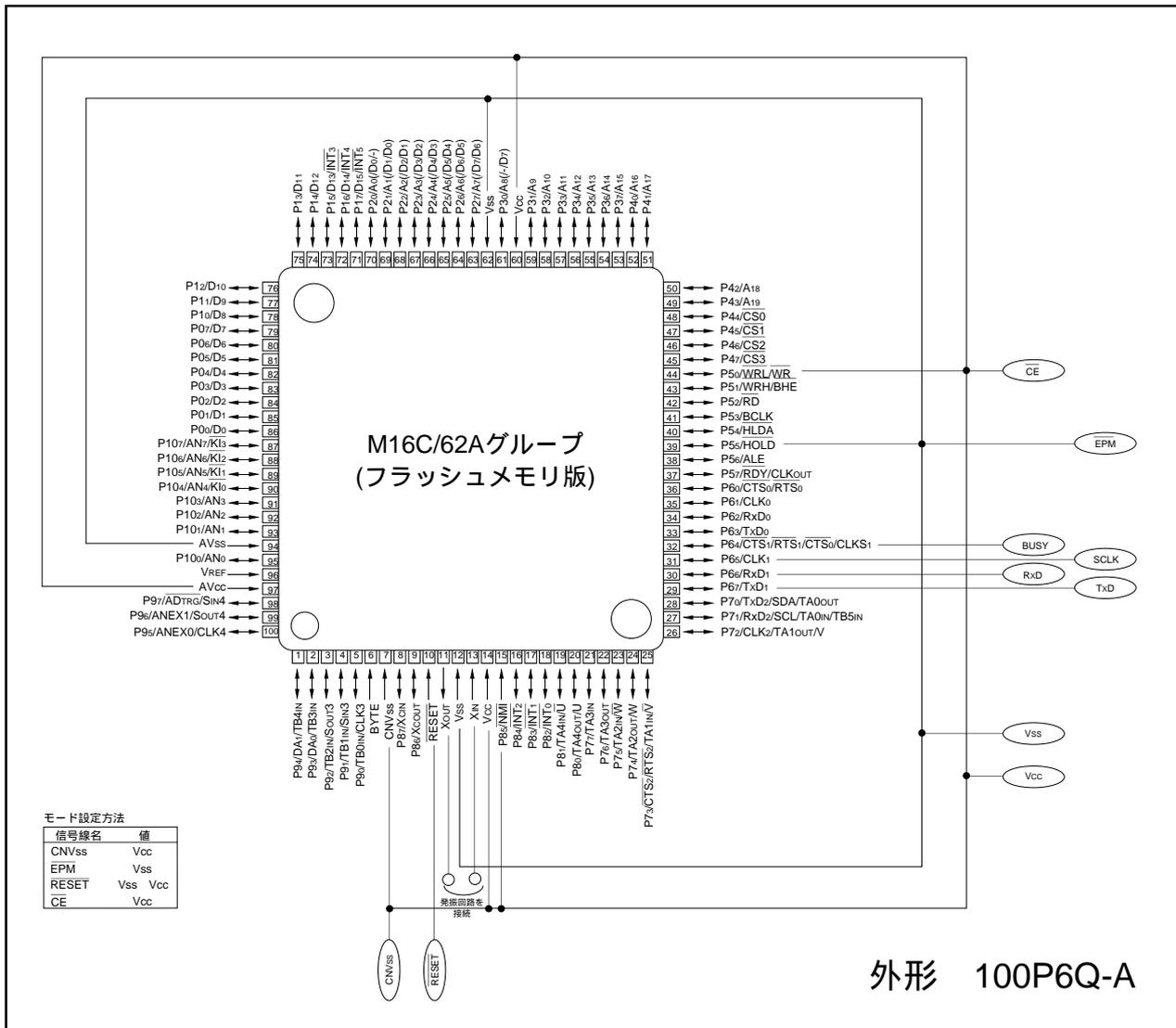
図1.29.2. 標準シリアル入出力モード時の端子結線図(2)
