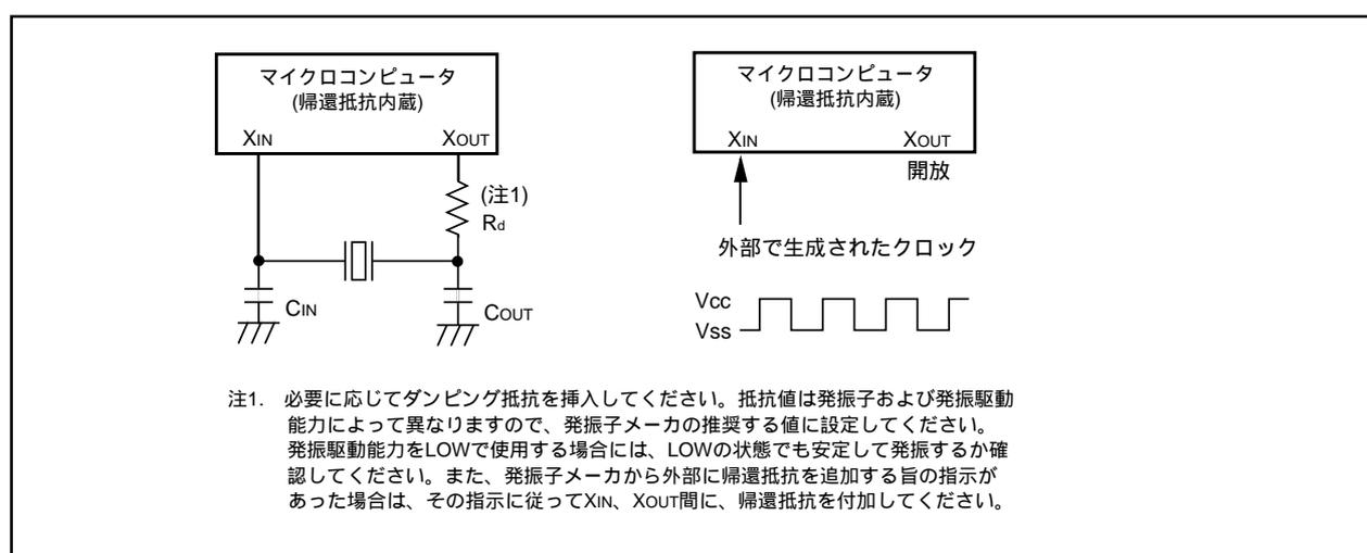
図1.10.1. メインクロックの接続例
