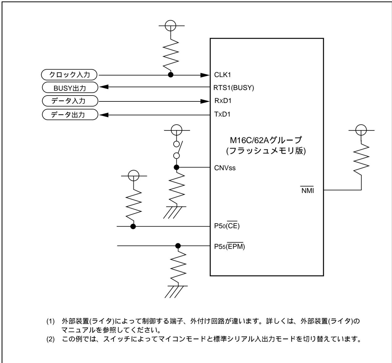
図1.29.21. 標準シリアル入出力モード1時の応用回路例
