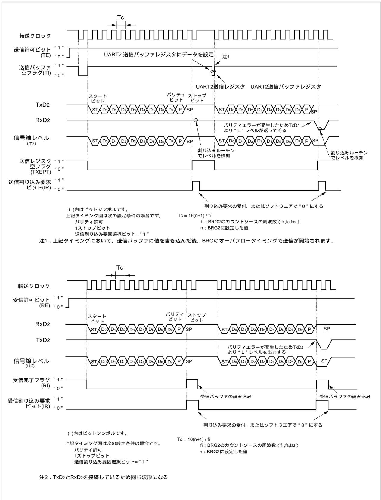
図1.16.22. UARTモード(SIMインタフェース対応)の送受信タイミング例
