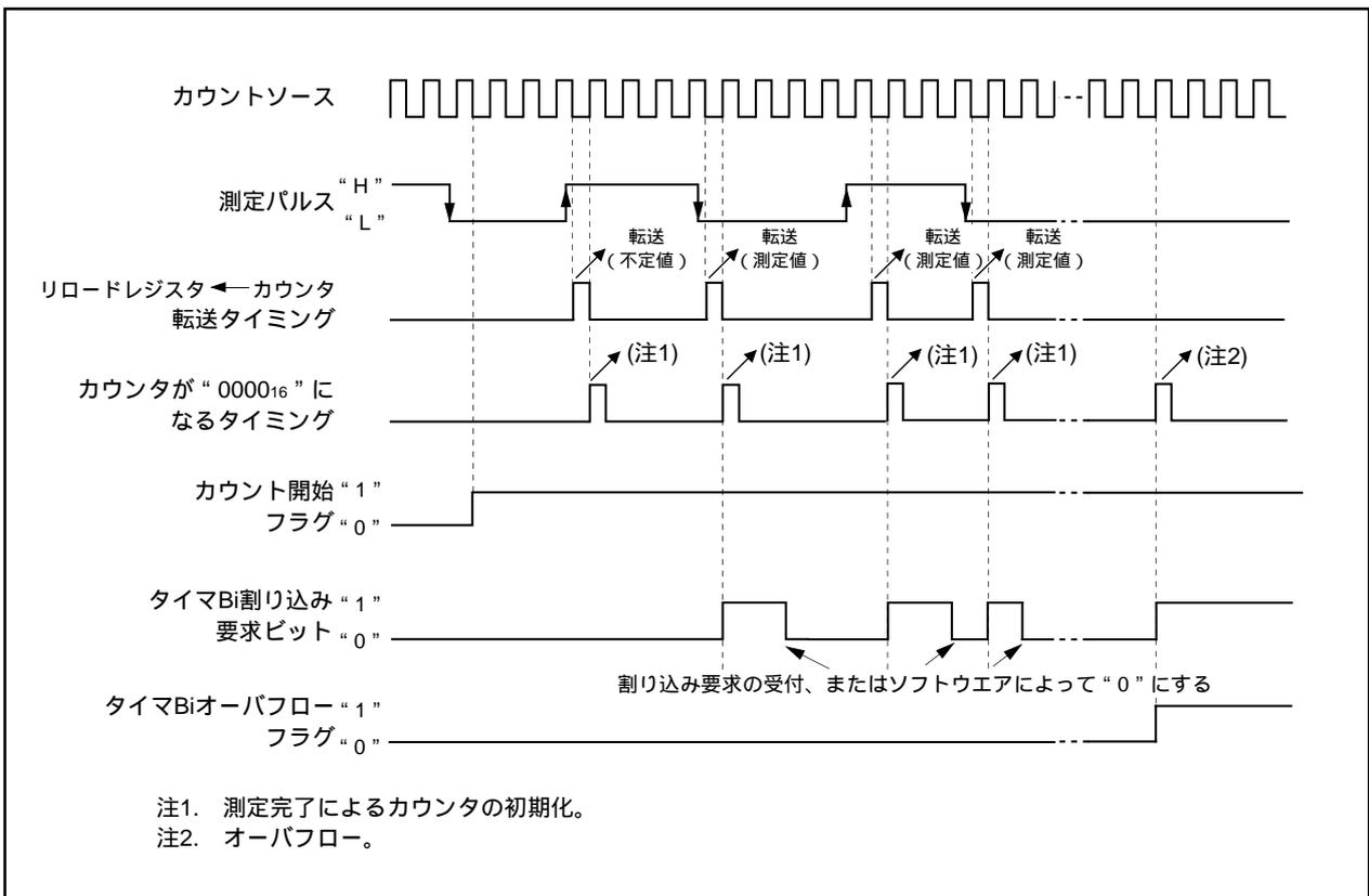
図1.14.21. パルス幅測定時の動作図
