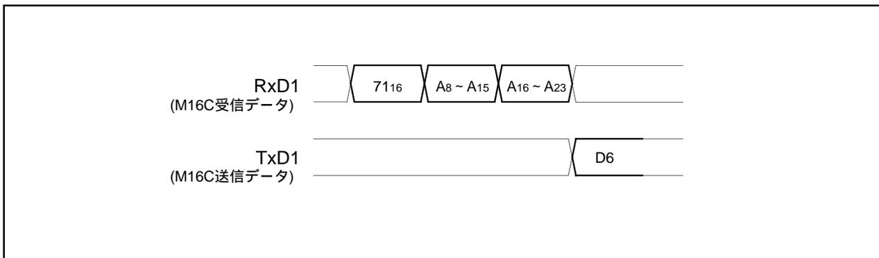
図1.29.30. リードロックビットステータスコマンド時のタイミング
