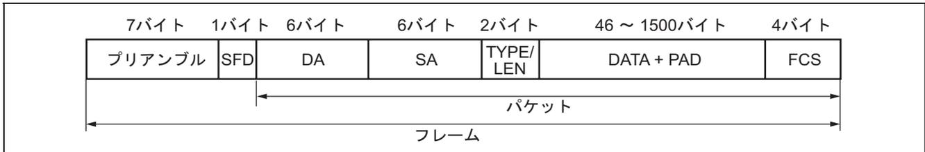
図 4.2 ベーシック・フレームの構造
