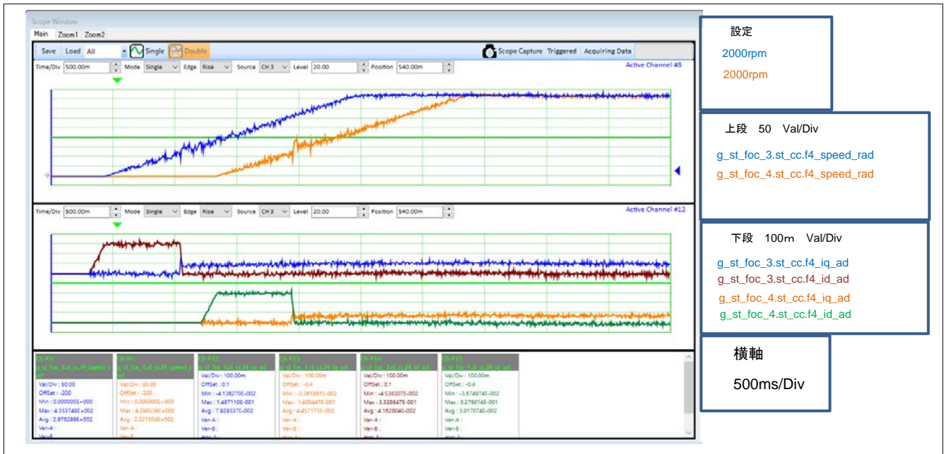
図 5-3 起動時駆動波形（3/3）（モータ 3、モータ 4）
