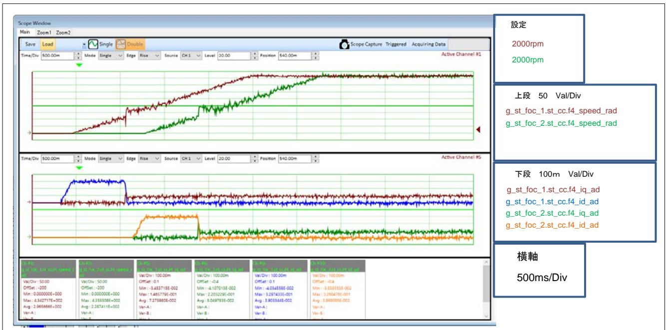
図 5-2 起動時駆動波形（2/3）（モータ 1、モータ 2）
