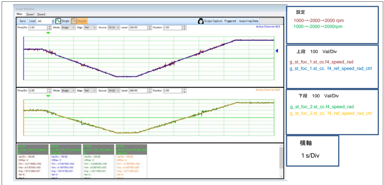
図 5-5 過渡時駆動波形（1/2）（モータ 1、モータ 2）
