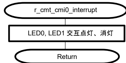
図 2-4 : タイマ割り込み動作フロー
