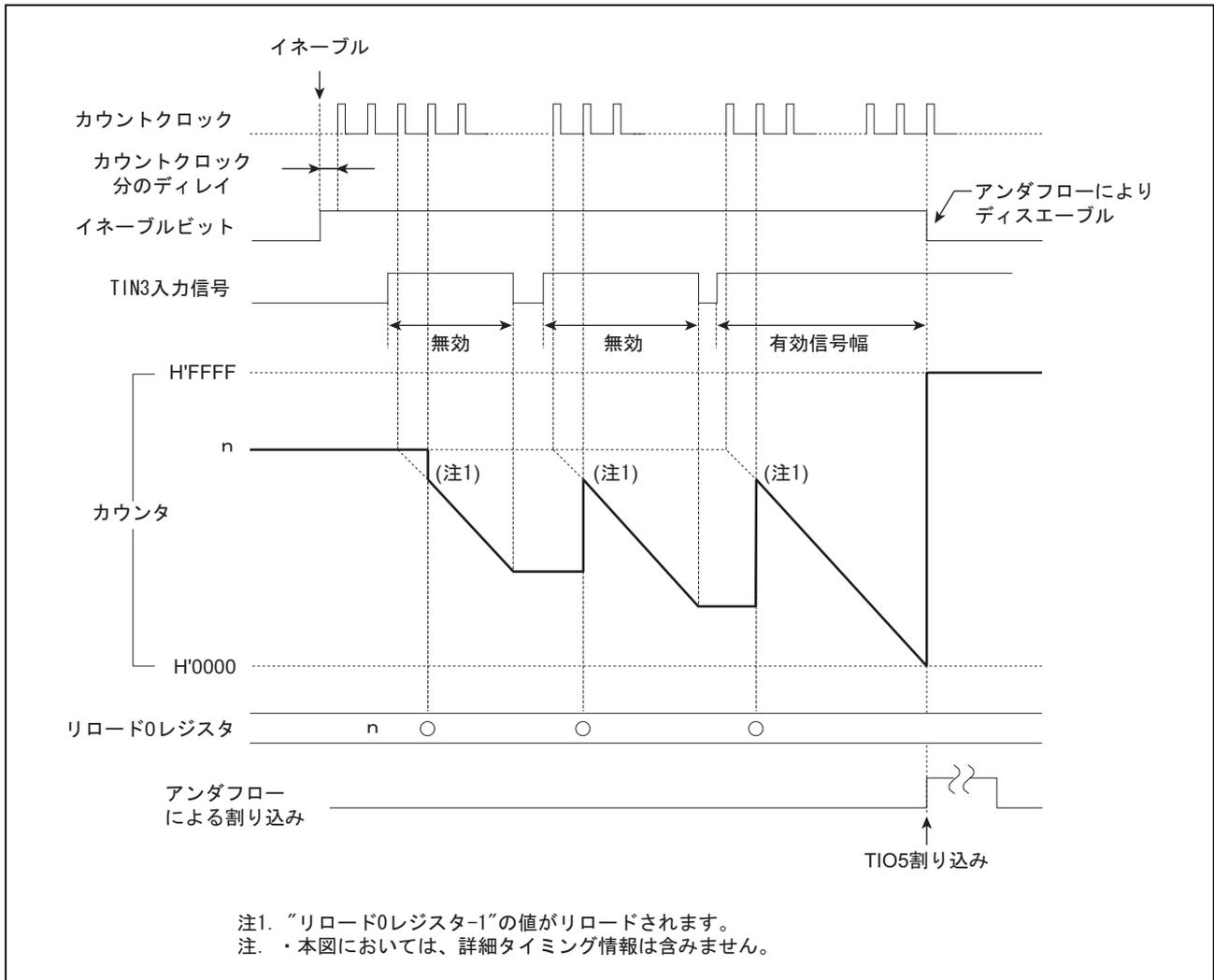
図 4.5.1 TIO ノイズ処理入力モードタイミング図
