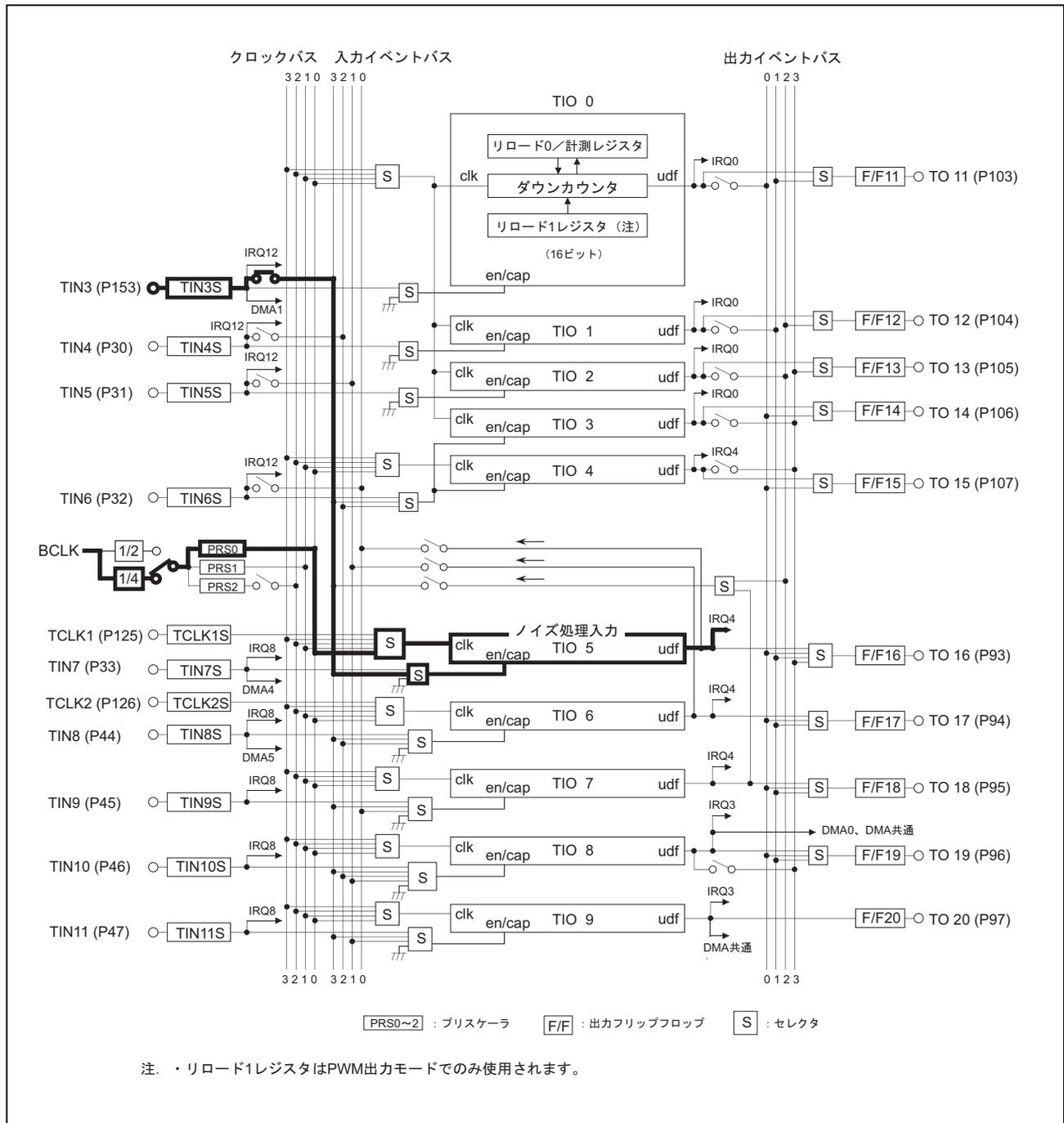
図 4.1.1 TIO ノイズ処理入力タイマ構成図
