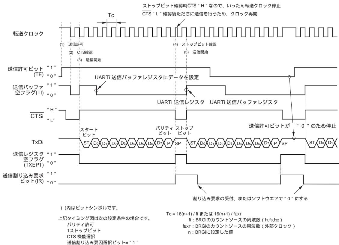
図1 クロック非同期形シリアル I/O モードの送信動作タイミング
