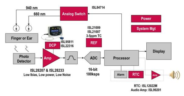
FIGURE 4. BLOCK DIAGRAM FOR PULSE OXIMETRY SYSTEM
