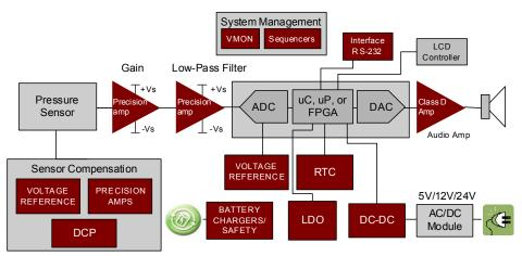
FIGURE 2. BLOCK DIAGRAM OF A BLOOD PRESSURE SYSTEM
