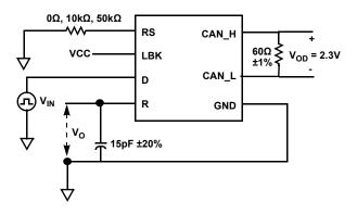
$\rm V_{IN}$  = 125kHz, 0V to  $\rm V_{CC},$  Duty Cycle 50%,  $\rm t_r$  =  $\rm t_f \leq 6ns$
