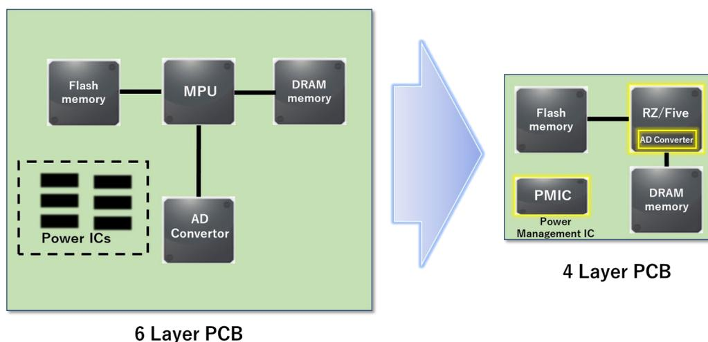
図 4. システムコスト低減の仕組み
