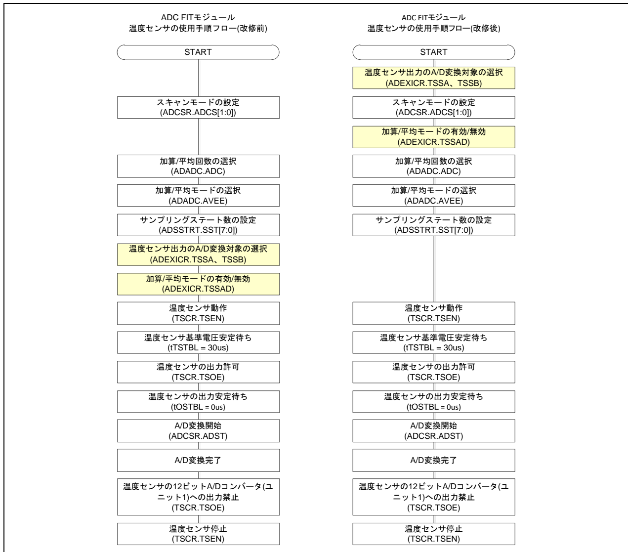
図 1 温度センサの使用手順フロー
