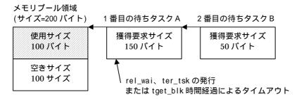
上図のように、200 バイトのメモリプール(使用サイズ 100 バイト、空き領域サイズ 100 バイト)に対して、150 バイトの獲得要求によりタスク A が待ちになり、その後 50 バイトの獲得要求によりタスク B が待ちになった状態で、タスク A が tget\_blk 時間経過によりタイムアウトするか、もしくはタスク A に対する rel\_wai、ter\_tsk の発行によりタスク A の待ち解除された場合、1 番目の待ちタスクになったタスク B のメモリブロック獲得処理が行われずタスク B の待ちが解除されません。
