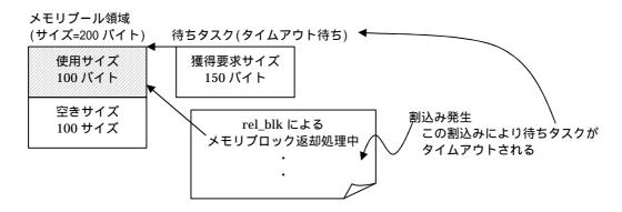
上図のように、メモリプールにタイムアウト付きの待ちタスクが存在する状況で、rel\_blk によりメモリブロックの返却処理を行っている最中にタイマ割込みが発生し、その時の待ちタスクの残り時間が0でタイムアウト処理がされた場合、メモリプール領域の使用サイズは150 バイト、空きサイズは50 バイトとなります。
