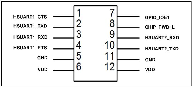
Figure 2. Pmod<sup>™</sup> Pin Diagram
