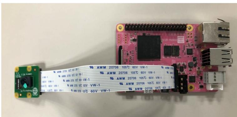
図 6-22 MIPI カメラの接続
