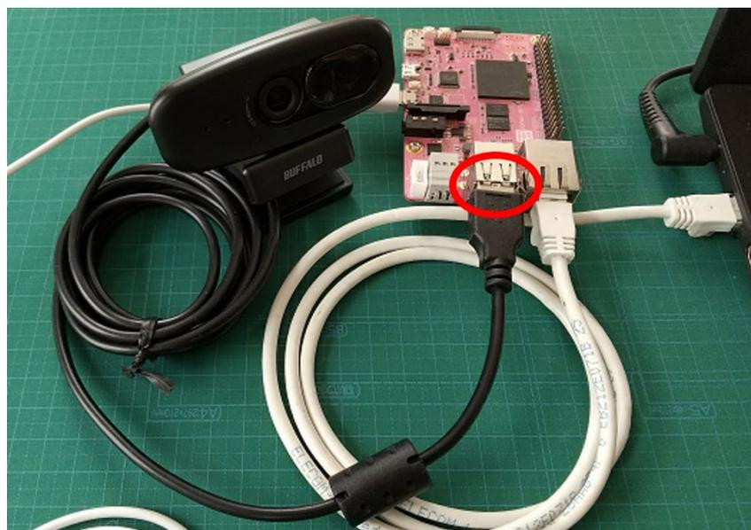
図 6-20 USB カメラの接続
