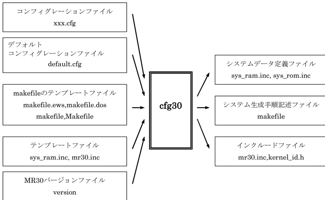
図 8.1 コンフィギュレータ動作概要
