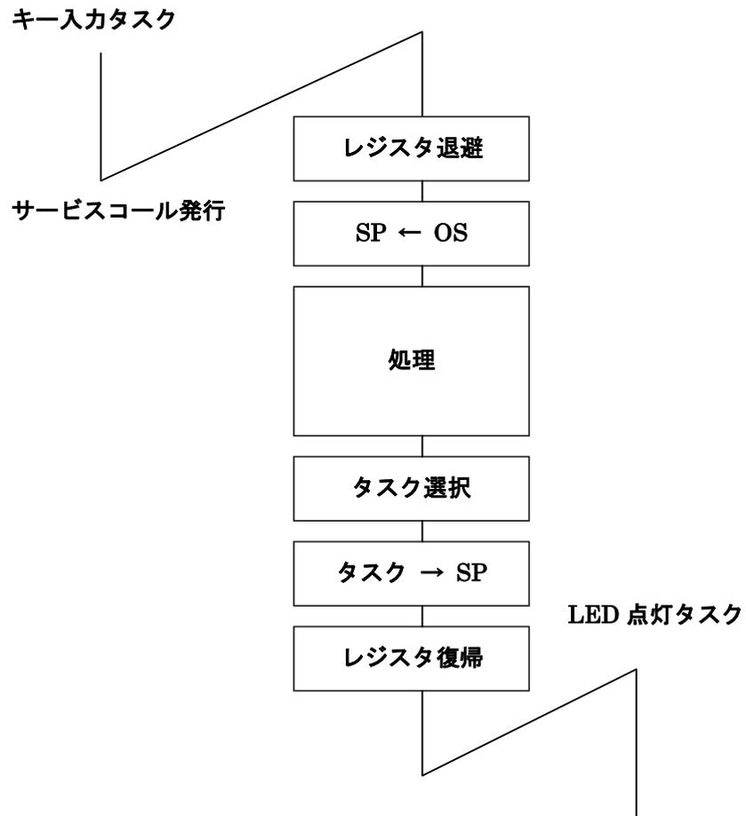
図 3.10 サービスコールの処理の流れ
