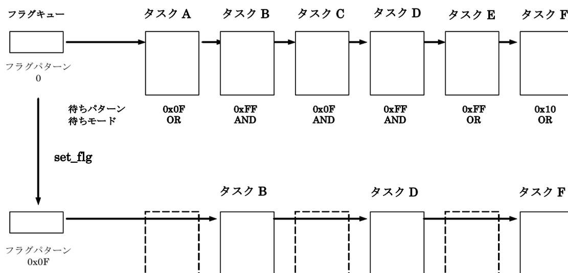
図 4.13 イベントフラグによるタスクの実行制御
