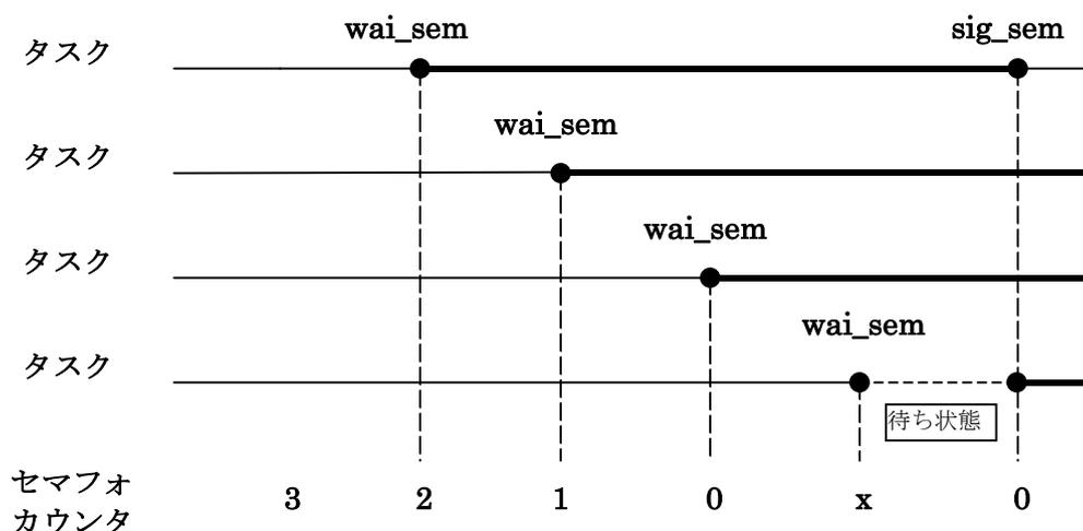
図 4.12 セマフォによるタスクの実行制御
