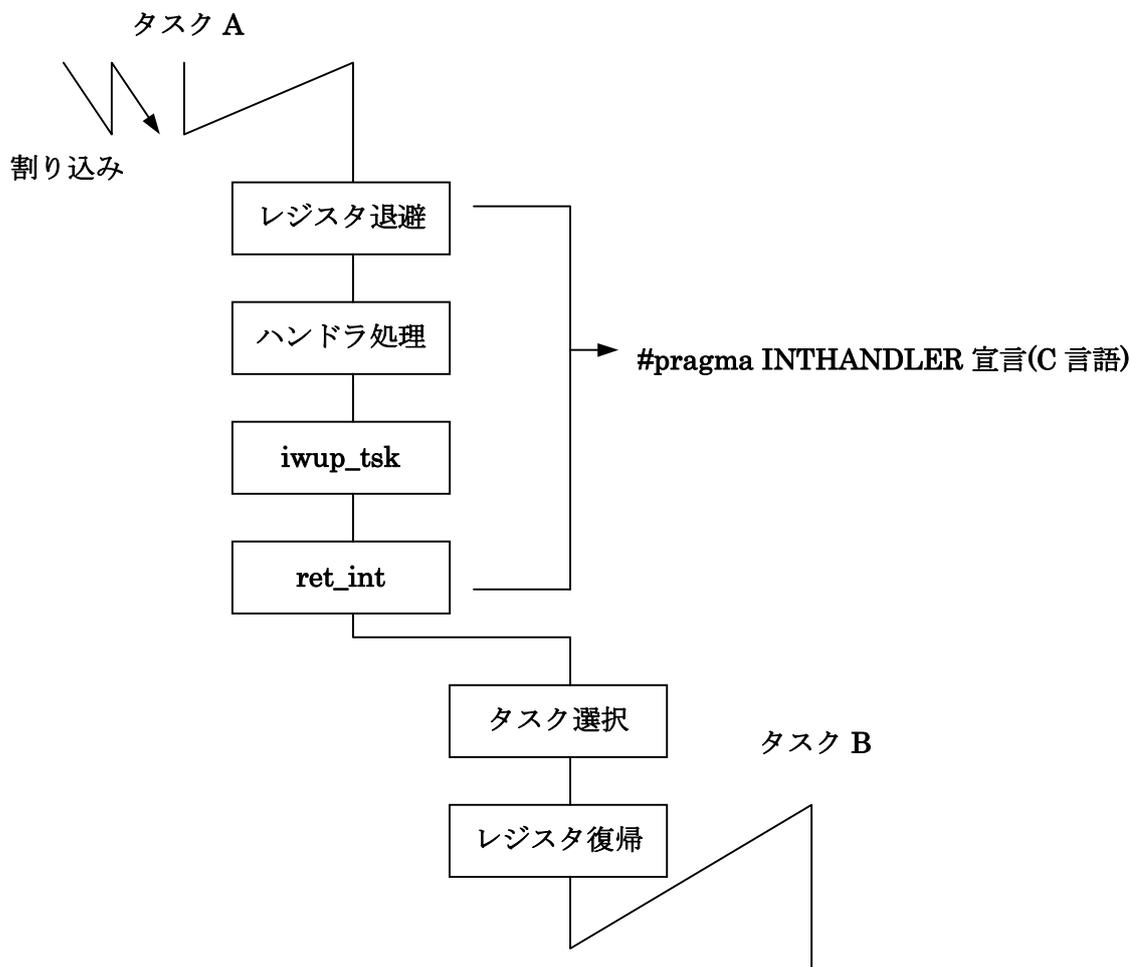
図 4.25 割り込み処理の流れ
