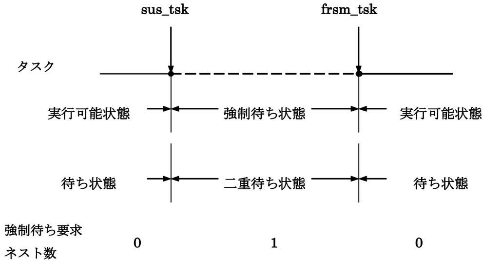
図 4.8 タスクの強制待ちと強制再開
