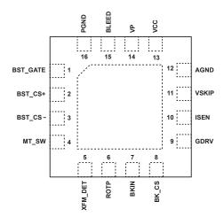
Figure 4.1 : 16-Lead QFN Package
