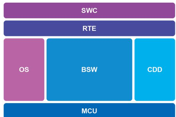
AUTOSARシステムにおけるRTE設定、BSWコンフィグレーション、SWC設計実装マイコン依存部へのOSポーティングなどを行います。また、お持ちのIPソフト資産をCDDとして流用する実装をサポートします。
