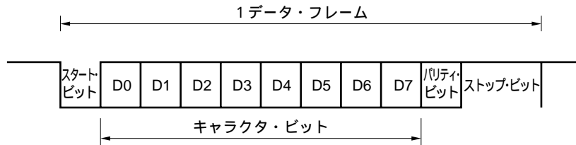
図17-8 アシncロナス・シリアル・インタフェースの送受信データのフォーマット
