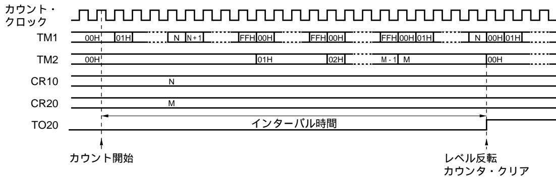
図9 - 13 方形波出力動作のタイミング
