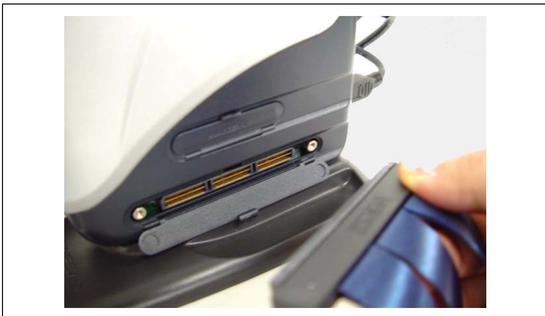
図 2.1 エバチップユニット使用時の E200F 側のトレースケーブル接続方法
