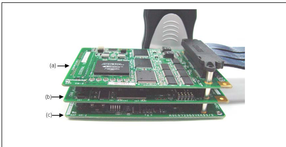
図 2.8 外部バストレーユニット、エミュレーションメモリユニット、およびエバチップユニットの接続方法
