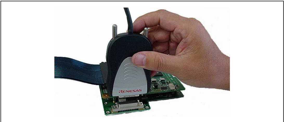
図 2.5 先端プローブとエバチップユニットの接続方法
