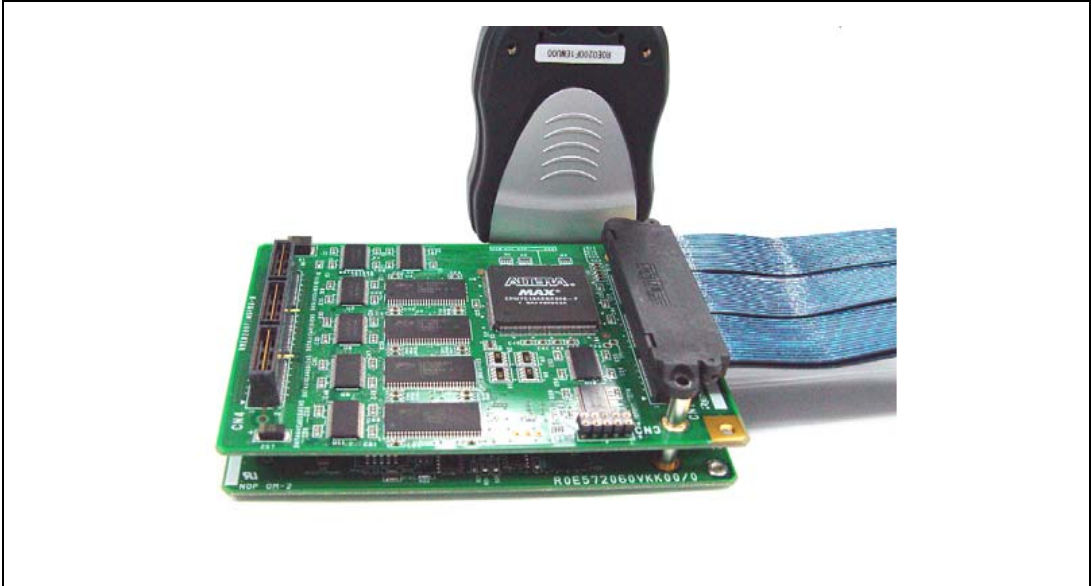
図 2.7 エミュレーションメモリユニット、エパチップユニット、およびトレースケーブルの接続方法
