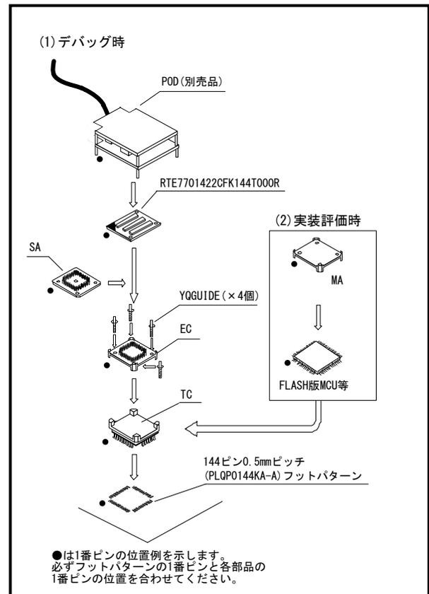
図2 RTE7701422CFK144T000Rの用途
