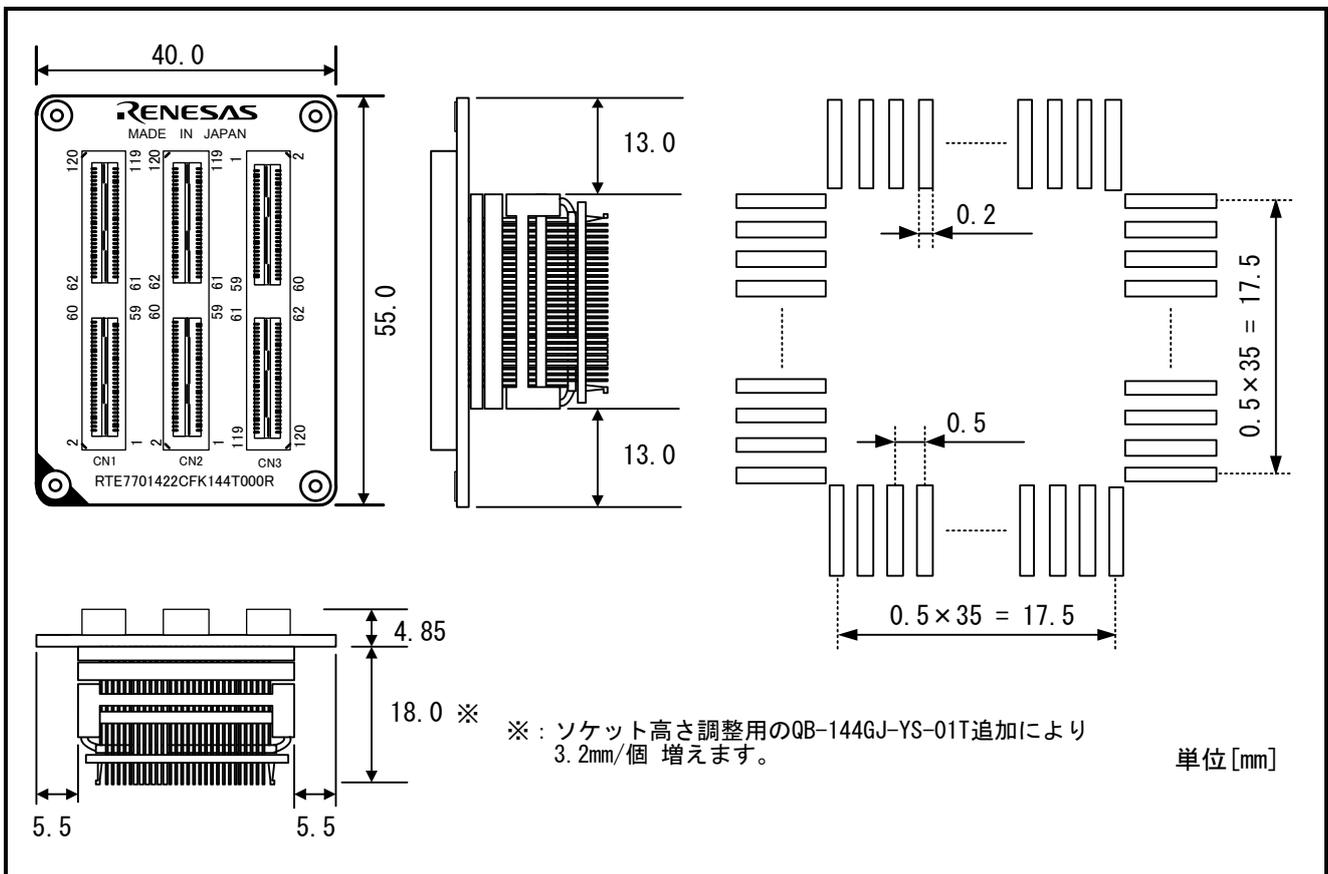
図5 寸法図及び参考フットパターン
