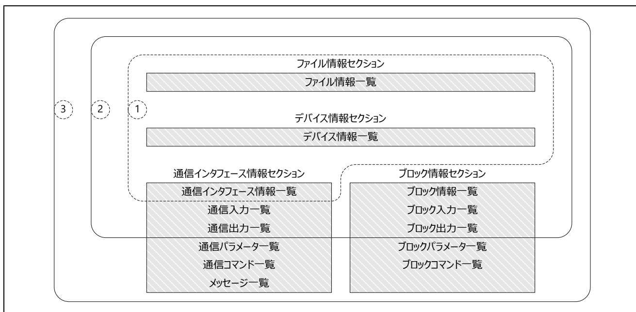
図 2.3 CSP+ファイルのセクション構成
