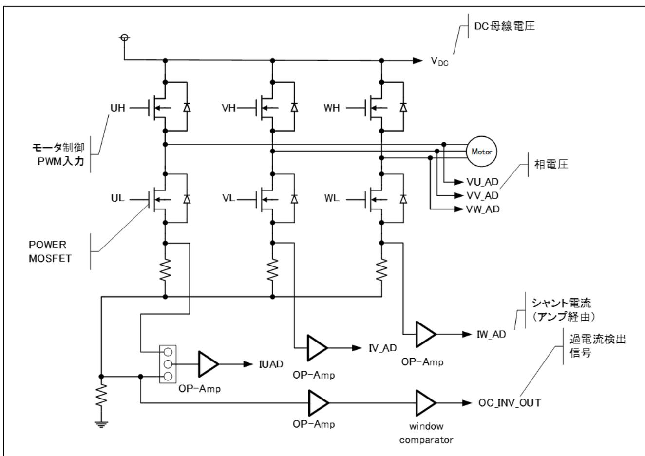
図 5-1 インバータ制御回路
