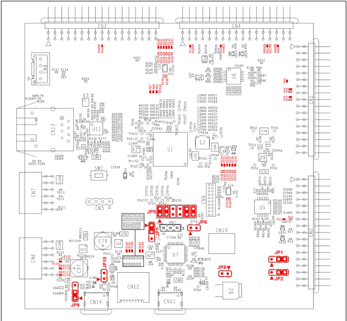
図 4-7 CPU ボードジャンパーピンの確認
