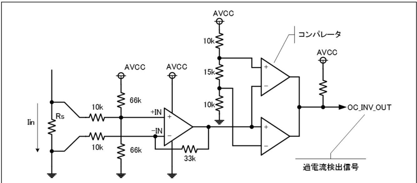
図 5-3 過電流検出回路
