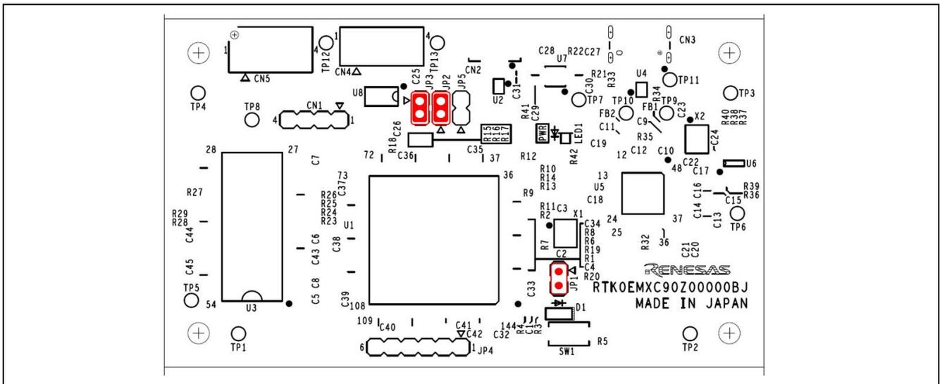
図 4-8 通信ボードジャンパーピンの確認
