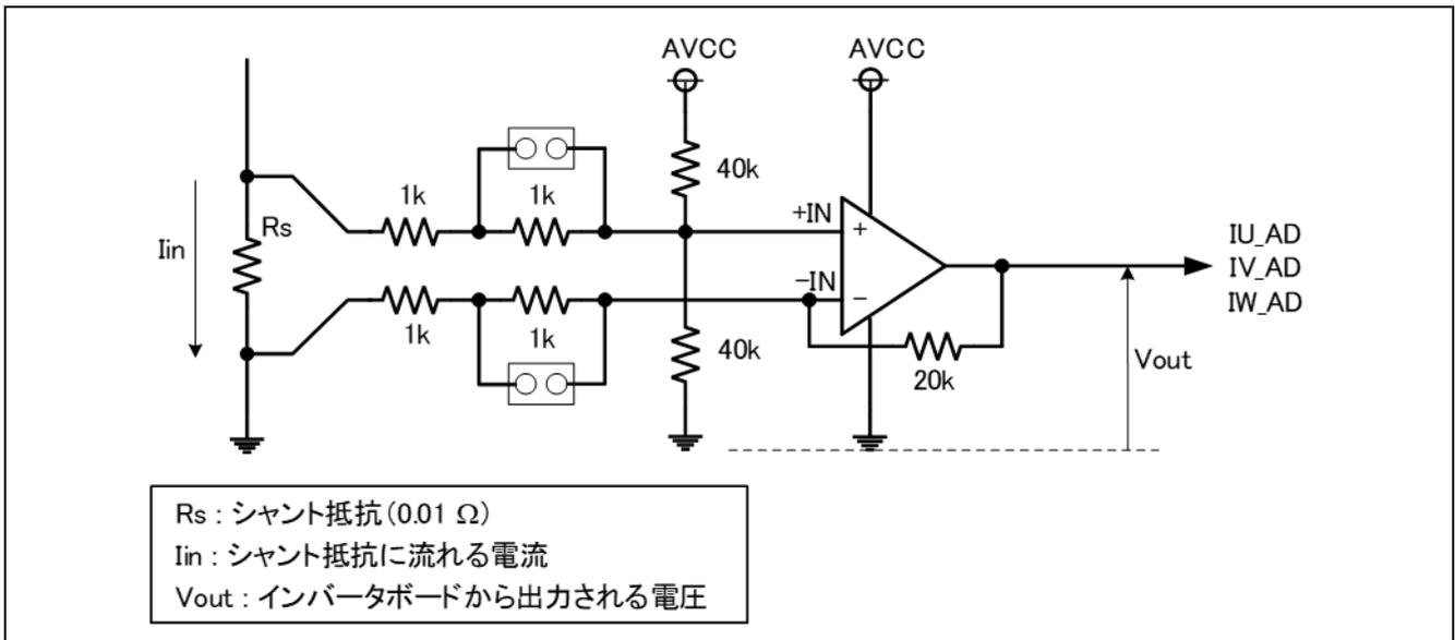
図 5-2 電流検出回路
