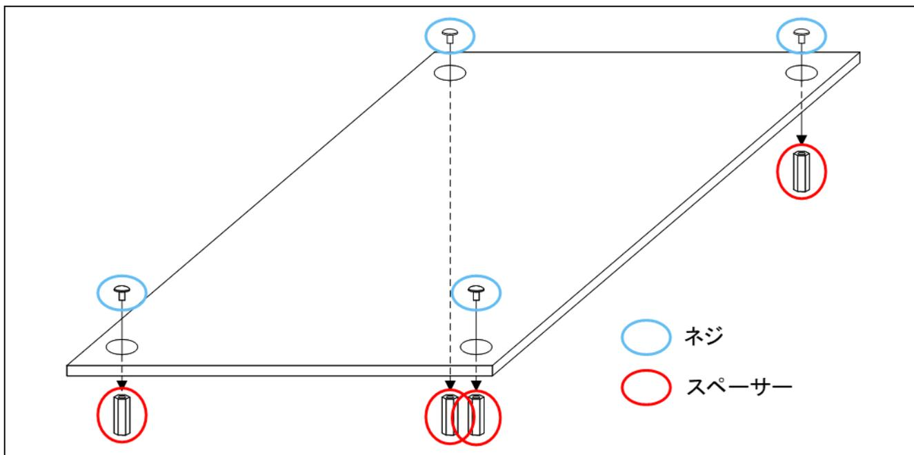
図 4-5 スペーサおよびネジの取り付け
