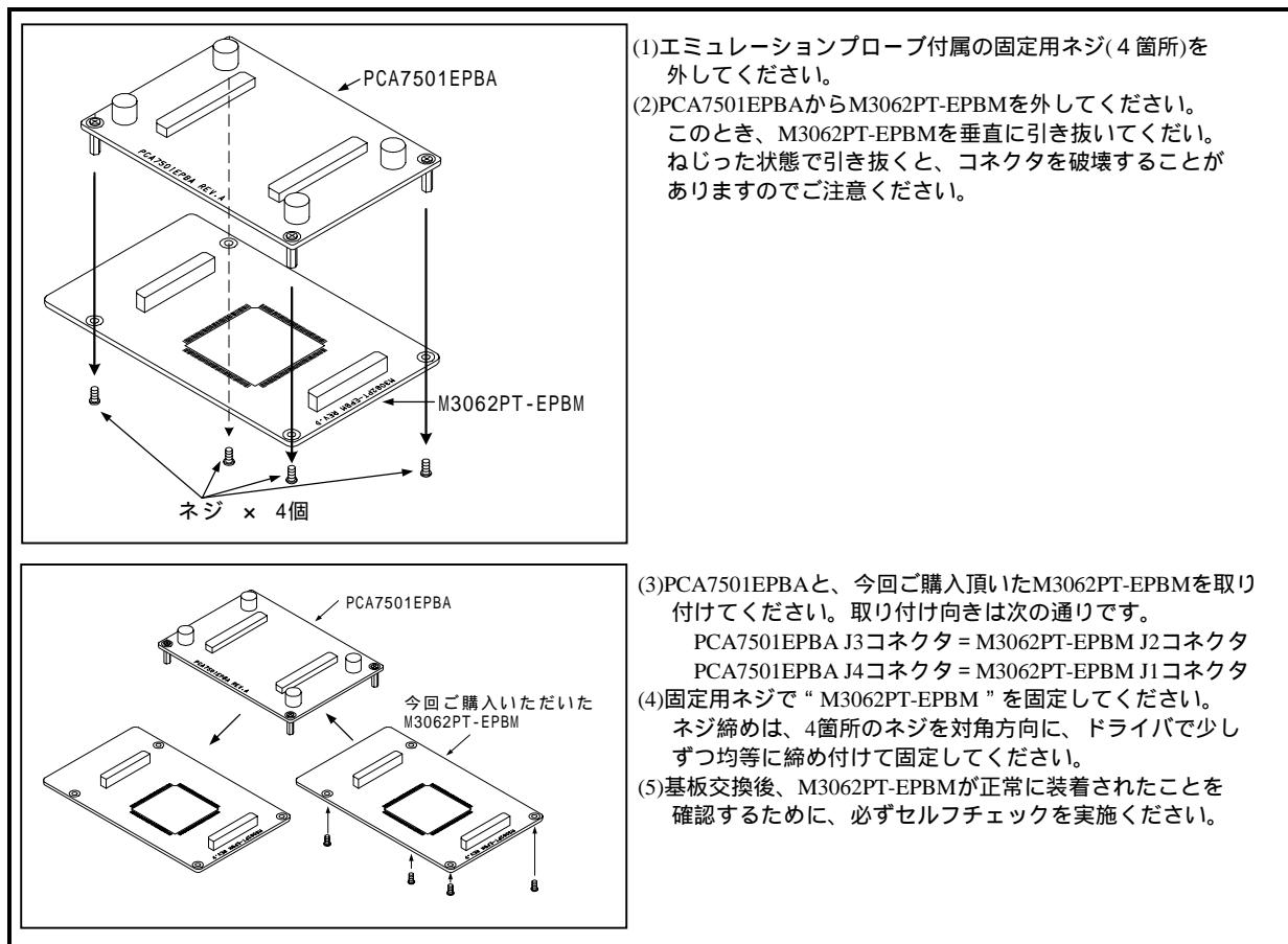
図3.1 MCU基板の交換方法
