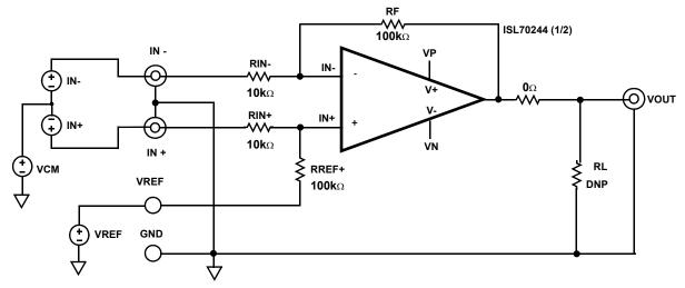
FIGURE 2. BASIC AMPLIFIER CONFIGURATION
