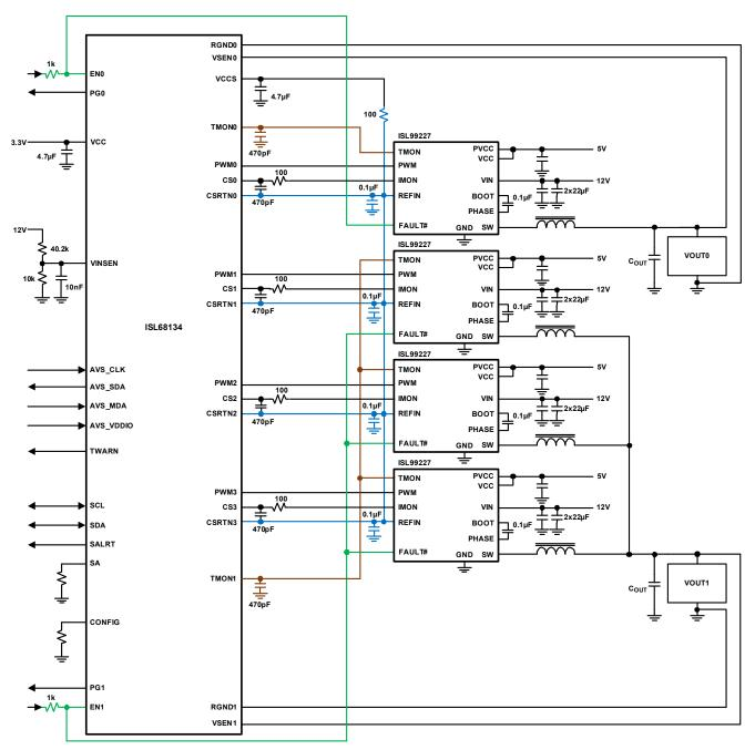
FIGURE 1. ISL68134-31P-EV1Z BLOCK DIAGRAM
