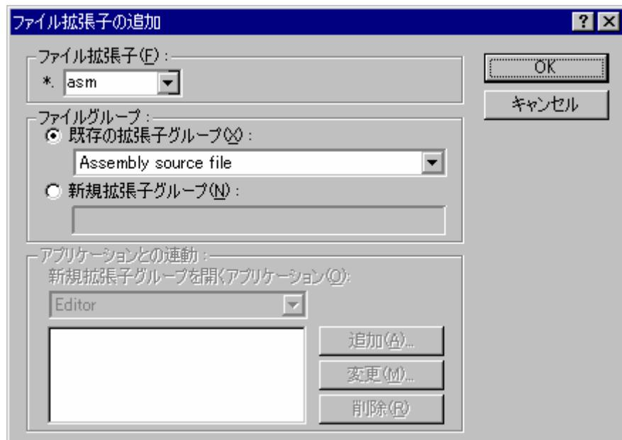
3. [ファイル拡張子]に定義する拡張子を入力してください。ドロップダウンリストには、現在のプロジェクトで未定義のすべての拡張子が含まれます。この拡張子のうち1つを選択すると、ファイル拡張子フィールドにテキストを自動的に表示します。
