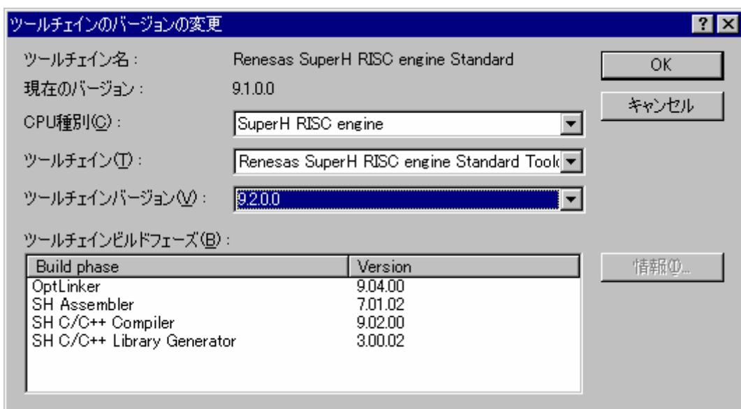
ツールチェインを構成するツールの情報を表示するには[ツールチェインのバージョンの変更]ダイアログボックスの[ツールチェインビルドフェーズ]ドロップダウンリストからツールを1つ選択し、[情報]ボタンをクリックしてください。ツール情報ダイアログボックスにそのツールの情報を表示します。このダイアログボックスを閉じるには[閉じる]ボタンをクリックしてください。
