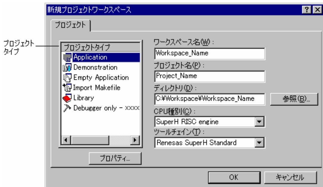
[新規プロジェクトワークスペース]ダイアログボックスを使用して、ターゲットCPUに合ったプロジェクト生成タイプを選択できます。
