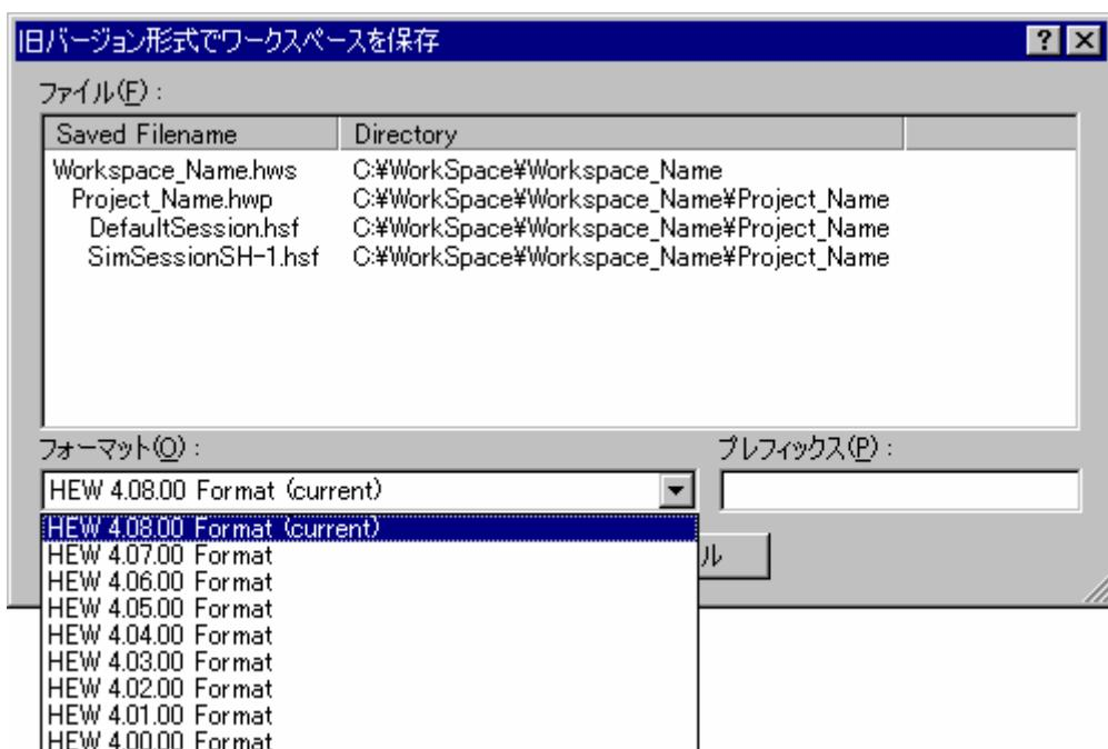
このダイアログボックスには、現在のワークスペースに関連するファイルのリスト、選択可能なバージョンをリストアップしたドロップダウンリスト（デフォルトで現在のバージョンを選択）、関連するファイル名を一括して変更するために短いプレフィックスを入力できるエディットボックスがあります。プレフィックスを変更すると、[ファイル]リストの表示を新しい名前で更新します。
