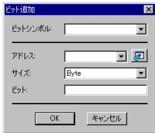
2. テストイメージファイルに保存するビット形式のウォッチポイントは、[ビットシンボル]、[アドレス]、[サイズ]、および[ビット]で指定します。
