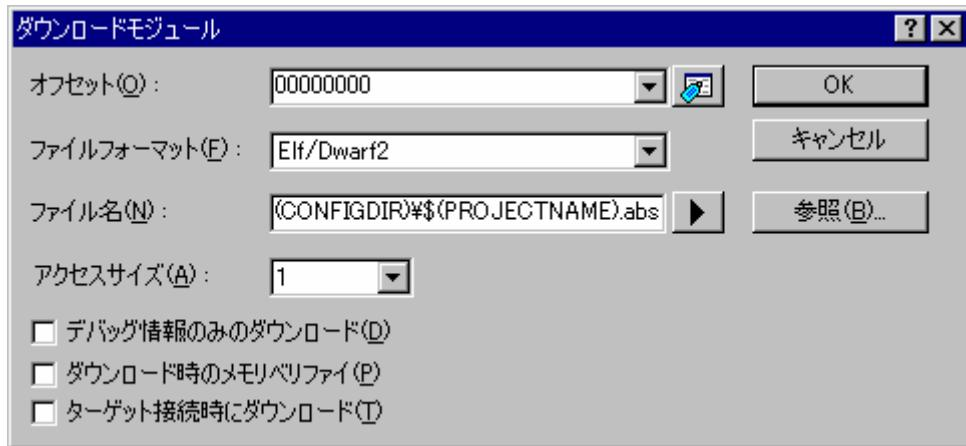
2. [オフセット]には、モジュールがロードされるメモリアドレスのオフセットを指定してください。デフォルトは0です。モジュールの追加後、[デバッグ -> ビルド]のサブメニュー、ワークスペースウィンドウの[Projects]タブの[Download modules]フォルダ内、および[ファイル -> 最近ダウンロードしたモジュール]のサブメニューで、モジュール名の右横にオフセット値が表示されます。
