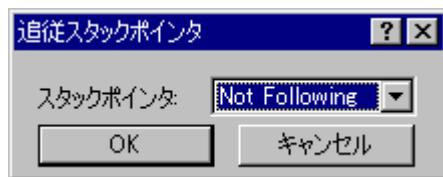
ドロップダウンリストで追従するスタックポインタを選択してください。メモリウィンドウは、そのスタックポインタ位置を追従して表示アドレスを自動的に変更します。[追従スタックポインタ]ダイアログボックスで[Not Following]を選択するとスタックポインタ位置の追従を終了します。
