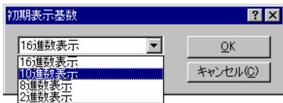
リストボックスで基數を選択してください。次回登録時より、指定した基數で変数が表示されます。
