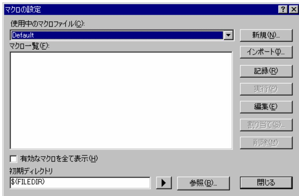
[使用中のマクロファイル]ドロップダウンリストにはHigh-performance Embedded Workshopシステムで現在使用中のマクロファイルをすべて表示します。これらのファイルは、各ユーザプロファイルのアプリケーションデータフォルダにあるHigh-performance Embedded Workshop管理情報フォルダ下の"Macros"フォルダに格納しています。"Macros"フォルダにコピーしたファイルはすべて自動的に[使用中のマクロファイル]ドロップダウンリストに追加します。
