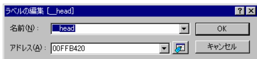
ラベル名と対応する値を編集して、[OK]ボタンを押すとラベルリストに編集を反映し、保存します。多重定義関数やクラス名を入力したときは、[関数選択]ダイアログボックスが開くので、関数を選択して[アドレス]を設定します。詳細は「17.18.2.3 複数ラベルをサポートする」を参照してください。
