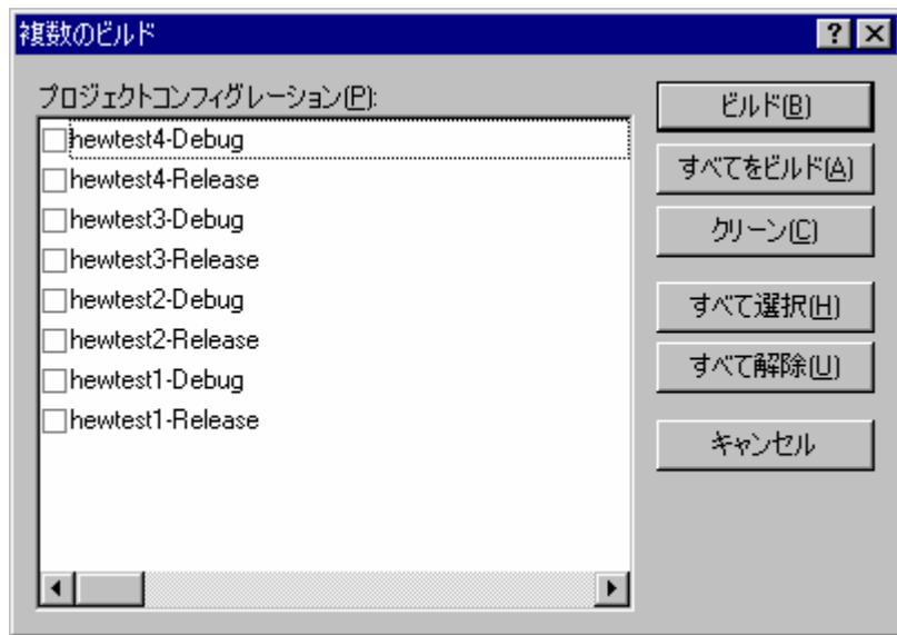
3. 項目を選択したら、[ビルド]ボタンをクリックしてください。選択したプロジェクトやコンフィグレーションのビルドを開始します。
