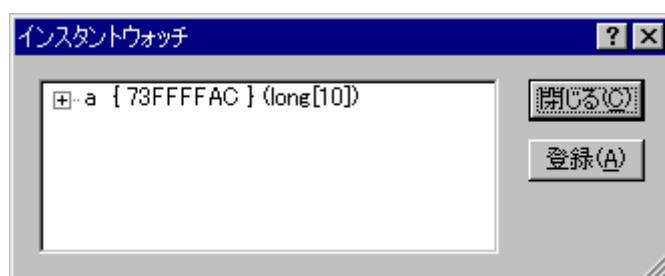
変数名の左側の'+'記号はクリックすれば情報を展開表示できることを、'-'記号は情報を縮小表示できることを示します。[登録]ボタンをクリックすると、変数をウォッチウィンドウに登録して、ダイアログボックスを閉じます。[閉じる]ボタンをクリックすると、変数をウォッチウィンドウに登録しないで、ダイアログボックスを開じます。
