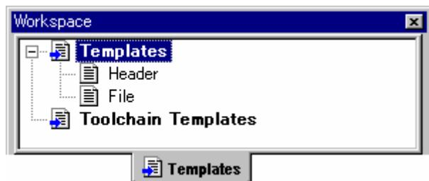
High-performance Embedded Workshopで追加した新しいテンプレートを[Templates]フォルダの下に表示します。[Toolchain Templates]フォルダには、現在のツールチェインによってHigh-performance Embedded Workshopシステムで使用するために提供される読み取り専用のテンプレートを表示します。この一覧にあるテンプレートはドラッグアンドドロップしてエディタファイルに挿入できます。さらに、エディタからテキスト領域を[Templates]フォルダにドラッグアンドドロップして、簡単にテンプレートを作成することもできます。
