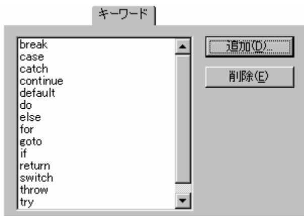
4. キーワードを追加するには[追加]ボタンをクリックしてください。[キーワード追加]ダイアログボックスを開きます。[キーワード]にキーワードを指定し[OK]ボタンをクリックしてダイアログボックスを閉じてください。キーワードを削除するには、キーワードを選択して[削除]ボタンをクリックしてください。
