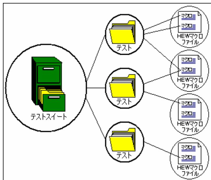
テストスイートは、現在のHigh-performance Embedded Workshopワークスペースに依存しません。このため、テストスイートを複数のワークスペースおよびプロジェクトで動作させ、1つのテストスイートで様々な状況のテストを行うことができます。テストスイート機能で使用できる"open\_workspace"および"change\_project"コマンドは現在使用しているワークスペースを変更できます。
