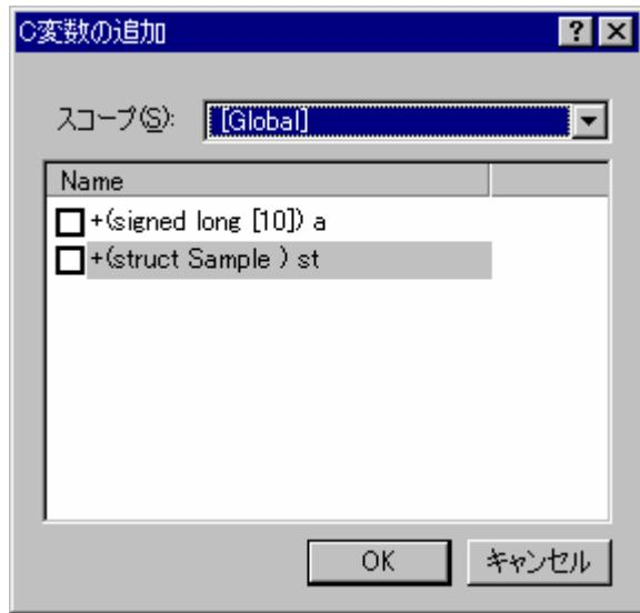
2. [スコープ]ドロップダウンリストには、[Global]、[Local]、およびファイル名の一覧を表示します。[スコープ]ドロップダウンリストで選択した項目によって、[Name]リストに表示する変数が変わります。[スコープ]ドロップダウンリストで[Global]を選択すると、[Name]リストにグローバル変数の一覧を表示します。また、[Local]を選択すると、現在のスコープ（プログラムカウンタ位置）で参照可能なローカル変数の一覧を表示します。また、ファイル名を選択すると、そのファイルが属するコンパイルユニットに含まれるファイルローカル変数の一覧を表示します。
