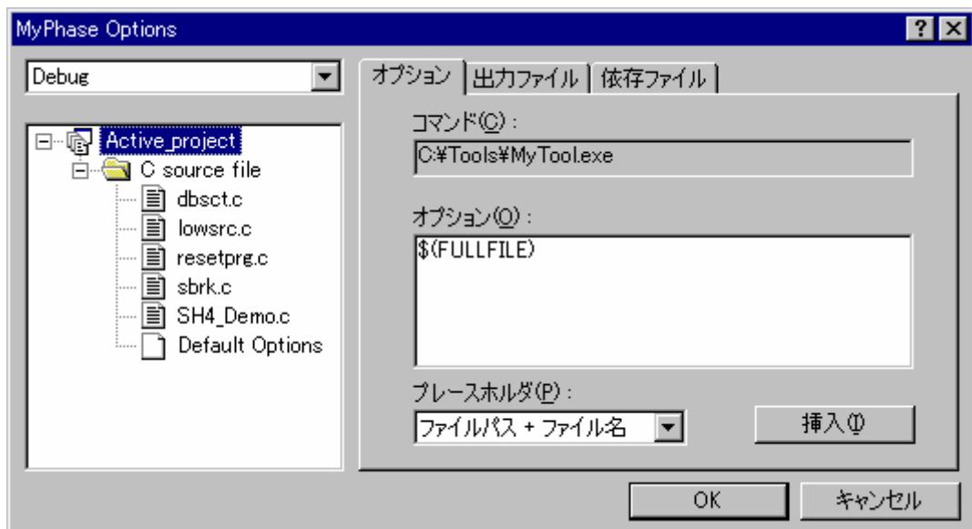
選択したフェーズが複数の場合、ダイアログボックスの左側にはプロジェクトファイルのリストが表示され、ファイル上でビルトオプションを指定できます。選択したフェーズが单一の場合、プロジェクトファイルのリストは表示されません。
