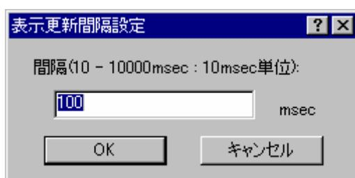
3. 更新間隔を10ms単位で入力します。更新間隔のデフォルト値は100msです。更新間隔の指定可能範囲はデバッガに依存します。
