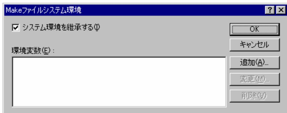
2. [システム環境を継承する]チェックボックスは、システム環境の継承を切り替える場合に使用します。チェックがオンの場合、Makeファイルを標準の環境で実行します（デフォルト）。チェックがオフの場合、Makeファイルを新規の環境で実行します。
