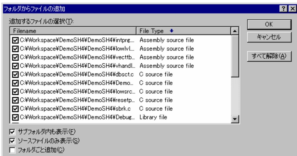
1. リストのカラムヘッダをクリックすると、そのカラムによってリスト項目をソートします。ダイアログボックスを表示したときは、ファイルタイプ(昇順)、ファイル名(昇順)の順にソートしています。
