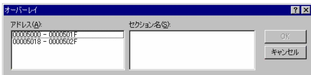
[アドレス]リストボックスは、オーバレイプログラムが使用するアドレス範囲を表示します。アドレス範囲の1つをクリックし[アドレス]リストボックスのアドレス範囲を選択します。
