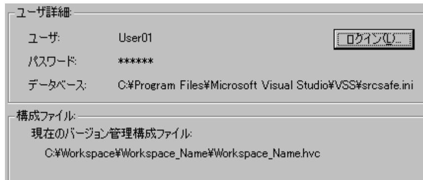
3. [ユーザ詳細]グループボックスにVisual SourceSafeにログインしているユーザ名、パスワード、およびデータベースを表示します。
