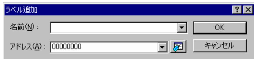
新しいラベル名を[名前]に入力し、対応する値を[アドレス]に入力して[OK]ボタンを押します。[ラベル追加]ダイアログボックスが閉じ、ラベルリストに新しいラベルを追加、更新します。多重定義関数やクラス名を入力したときは、[関数選択]ダイアログボックスが開くので、関数を選択して[アドレス]を設定します。詳細は「17.18.2.3 複数ラベルをサポートする」を参照してください。
