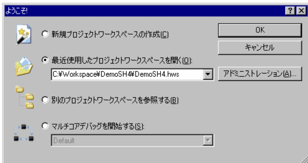
High-performance Embedded Workshopを起動しワークスペースを使用したことがある場合は、デフォルトで[最近使用したプロジェクトワークスペースを開く]ボタンが選択されています。一度もワークスペースを使用していない場合は、[新規プロジェクトワークスペースの作成]ボタンが選択されています。
