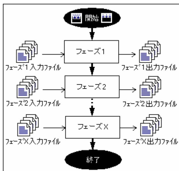
High-performance Embedded Workshopではビルド処理を変更できます。[ビルド > ビルドフェーズ]を選択し[ビルドフェーズ]ダイアログボックスを開きます。左には現在のプロジェクトで定義されたフェーズを示します。
