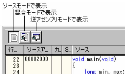
High-performance Embedded Workshop V.4.00以降のエディタでは、逆アセンブリ表示を統合しています。モードを切り替えるツールバーがあります。各モードが有効である場合、ボタンをクリックすると表示を切り替えます。
