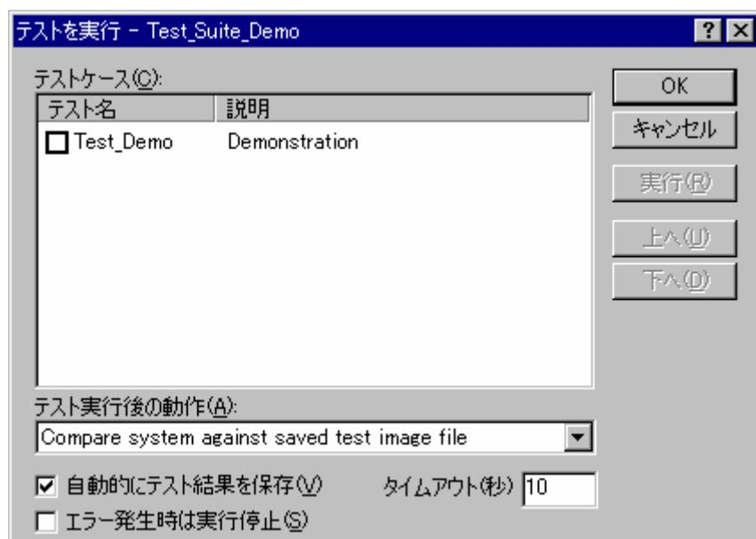
2. High-performance Embedded Workshopテストシステムで現在定義されているすべてのテストを[テストケース]リストに表示します。
