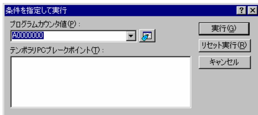
[条件を指定して実行]ダイアログボックスでは命令実行の条件を設定します。
