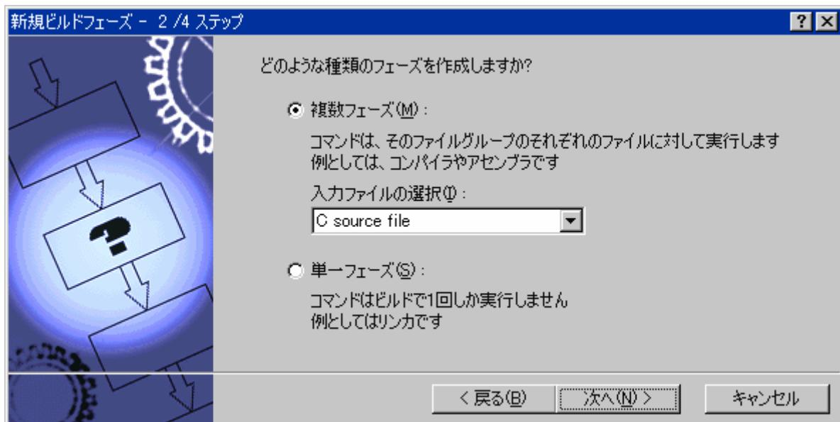
[入力ファイルの選択]ドロップダウンリストは、そのプロジェクト用に定義された現在のファイルグループを含みます。[入力ファイルの選択]ドロップダウンリストの中の[Multiple Groups]エントリを選択すると、複数の入力ファイルグループを定義できる[グループの選択]ダイアログボックスを開きます。
