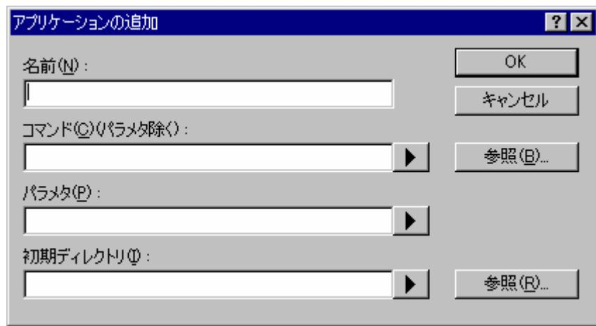
[名前]にアプリケーション名を入力します。[コマンド]にアプリケーションの絶対パスを入力します(パラメータは含めません)。[パラメタ]にファイルを開くのに必要なパラメータを入力します。必ず \$(FULLFILE) プレスホルダを使って入力ファイルを指定してください。(プレースホルダの詳細と使用方法については、「リファレンス 5. プレスホルダ」を参照してください。)[初期ディレクトリ] にアプリケーションを実行させる初期ディレクトリを入力します。[OK]ボタンをクリックするとアプリケーションを定義します。アプリケーションを変更するには[変更]ボタンをクリックしてください。[アプリケーションの変更]ダイアログボックスを開きます。このダイアログボックスは、[名前]が変更できないことを除いて[アプリケーションの追加]ダイアログボックスと同じです。設定を変更してから[OK]ボタンをクリックします。
