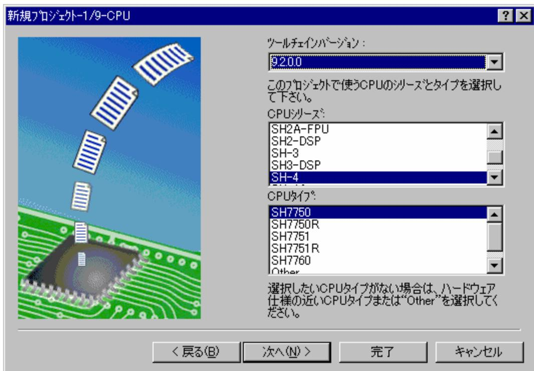
1. ステップ1ではツールチェインバージョンとCPUを選択します。使用するCPUの種類([CPU タイプ])はCPUのシリーズ([CPUシリーズ])ごとに分類しています。ツールチェインバージョン、[CPU シリーズ]、および[CPU タイプ]の選択により生成するファイルが異なりますので、開発するプログラムに対応した設定を選択してください。対応するCPUがない場合は、ハードウェア仕様の近いCPUまたは[Other]を選択してください。
