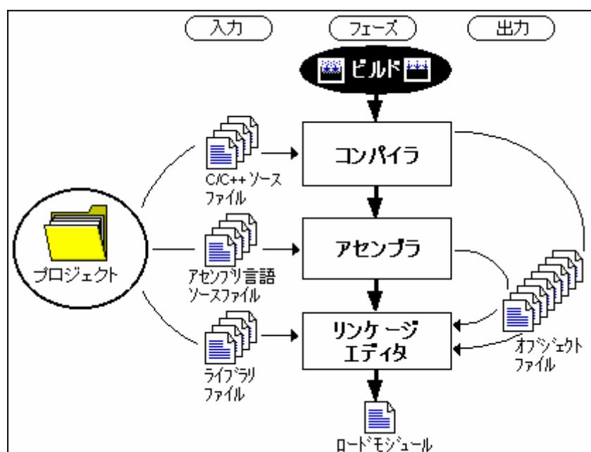
上記の例では、第一のフェーズがコンパイラ、第二のフェーズがアセンブラー、そして最後のフェーズがリンクエディタです。コンパイラのフェーズでは、プロジェクトのC/C++ソースファイルを順次コンパイルします。アセンブラーのフェーズでは、アセンブリ言語のソースファイルを順次アセンブルします。リンクエディタのフェーズでは、すべてのライブラリファイルと、コンパイラフェーズとアセンブラフェーズからの出力ファイルをリンクして、ロードモジュールを作成します。
