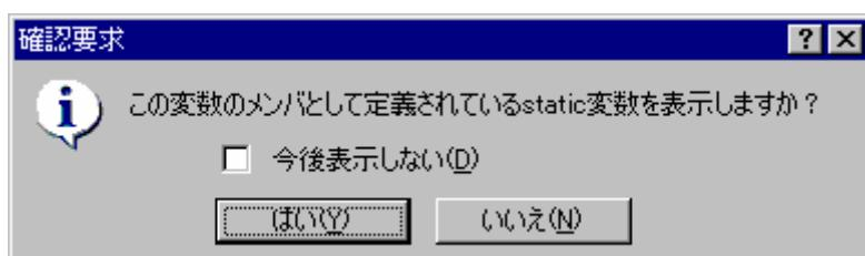
この操作により変数展開時にstaticメンバ変数を表示しなくなり、表示時間を短縮できます。（[いいえ]を選択した後もstaticメンバ変数を直接ウォッチウィンドウに追加することでstaticメンバ変数の参照は可能です）
