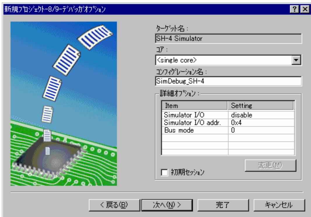
8. ステップ8では選択したデバッガターゲットのオプションを設定します。
