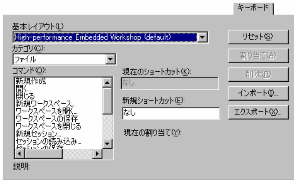
このダイアログボックスで、High-performance Embedded Workshopのデフォルトのキーボードショートカット、あるいは、PDデバッガショートカットのどちらかを選択できます。キーボードのレイアウト全体を変更するには、[基本レイアウト]ドロップダウンリストから項目を1つ選んでください。デフォルトでは、High-performance Embedded Workshop設定を使用しています。
