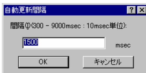
3. 更新間隔を10ms単位で入力します。更新間隔のデフォルト値、および更新間隔の指定可能範囲は、デバッガに依存します。
