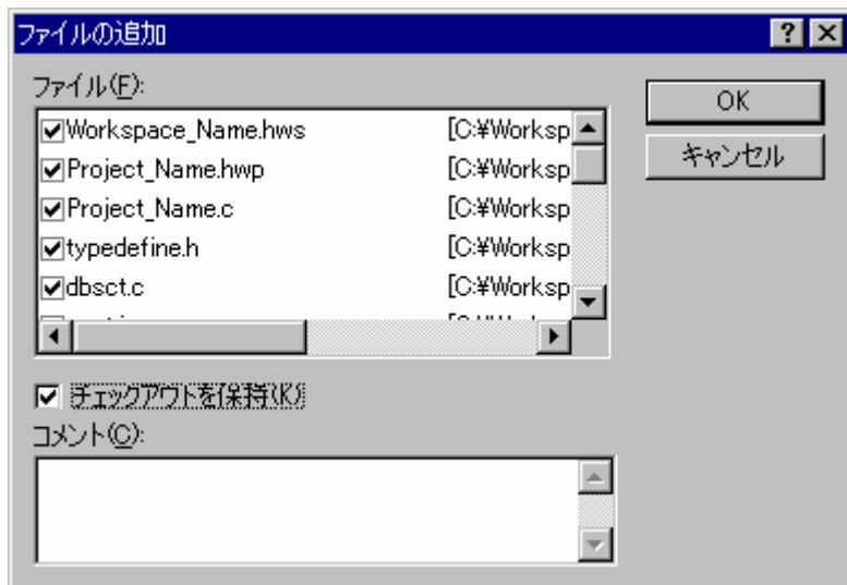
Visual SourceSafeにファイルを追加すると、作業中フォルダのローカルファイルは読み取り専用になります。ファイルを追加する際に[ファイルの追加]ダイアログボックスの[チェックアウトを保持]チェックボックスをオンにすると、ファイルを追加した後もファイルをチェックアウトされた状態で書き込み可能にできます。ファイルが追加されたことの確認や、プロジェクト内のすべてのファイル状態を表示するには、以下を行ってください。
