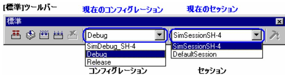
[標準]ツールバーに現在のコンフィグレーションおよび現在のセッションをドロップダウンリストボックスで表示します。
