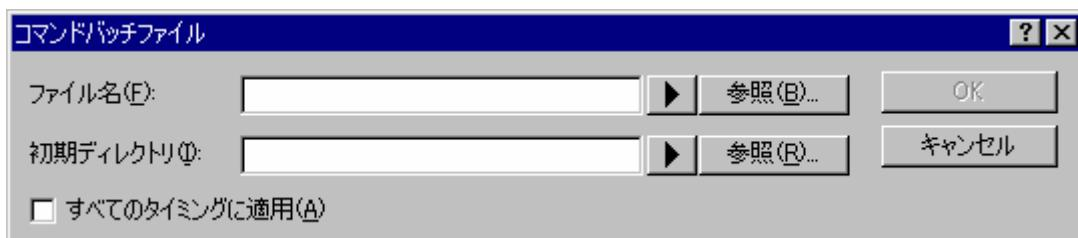
5. [ファイル名]にコマンドバッチファイルのファイル名を入力します。[ファイル名]にプレースホルダを挿入するには、プレースホルダボタン(▶)をクリックし、ポップアップメニューからプレースホルダを選択します。ファイルを参照するには[参照]ボタンをクリックします。
