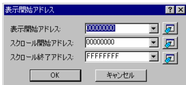
[OK]ボタンをクリックするか、'Enter'キーを押すとダイアログボックスは閉じてメモリウィンドウが開きます。
