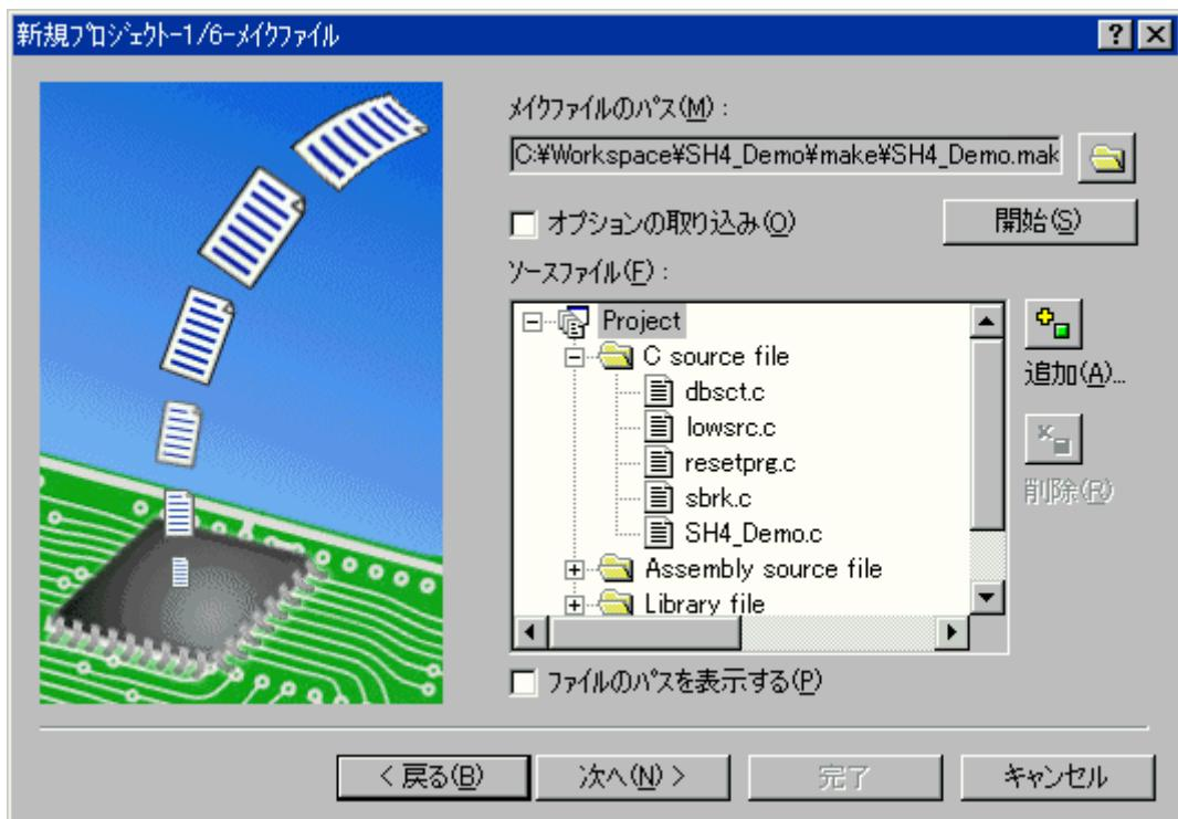
[マイクファイルのパス]でマイクファイルを選択すると[ソースファイル]にマイクファイルに登録されているソースファイルを表示します。マイクファイルに登録されているソースファイルを再び表示するには[開始]ボタンをクリックします。
