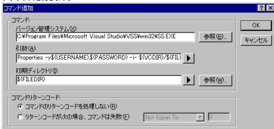
2. [バージョン管理システム]にコマンド実行ファイルの絶対パスを入力するか、[参照]ボタンをクリックしてコマンド実行ファイルの位置を指定してください。
