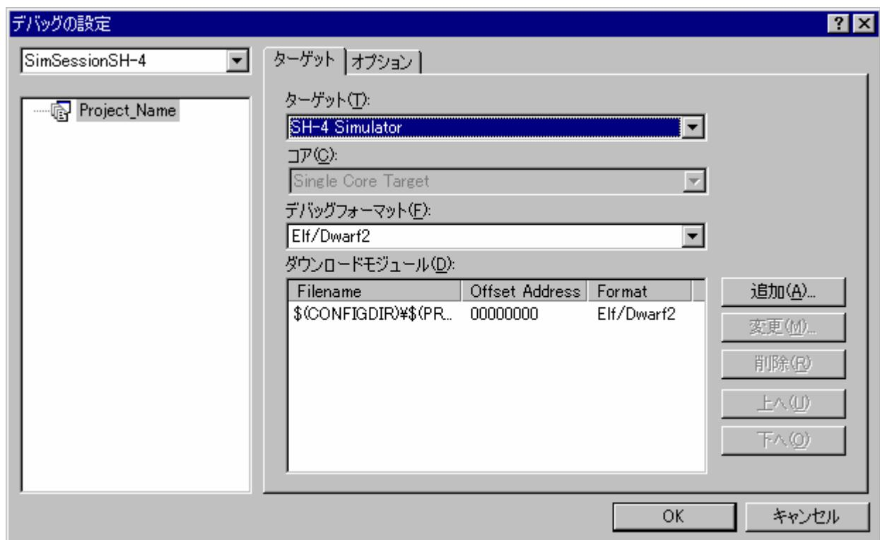
プロジェクトの作成後もダウンロードモジュールを手動で選択できます。これは、[デバッグの設定]ダイアログボックスを使用して行うことができます。このダイアログボックスでは、ワークスペース全体のデバッグの設定を制御できます。ダイアログボックスの左側にあるツリーには、現在のプロジェクトをすべて含んでいます。このツリーでプロジェクトを選択すると、そのプロジェクトの設定の表示、およびセッションドロップダウンリストには、セッションの選択を表示します。このリストボックスでは、複数のセッションの選択、また
