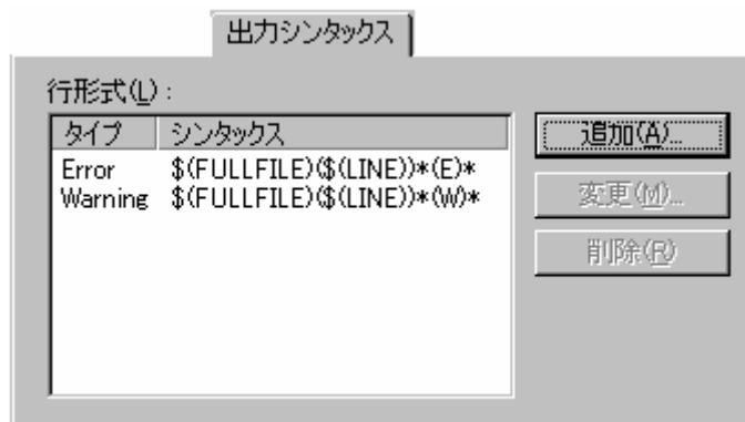
アウトプットウィンドウの[Build]タブに出力されるエラーメッセージが[出力シンタックス]の定義と一致する場合、そのエラーメッセージの左側にアイコンを表示したり、該当するソースコードをエディタで参照したりできます。
