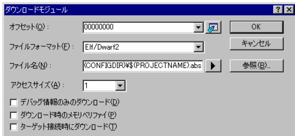
4. [オフセット]には、モジュールがロードされるメモリアドレスのオフセットを指定してください。デフォルトは0です。モジュールの追加後、[デバッグ -> ビルド]のサブメニュー、ワークスペースウィンドウの[Projects]タブの[Download modules]フォルダ内、および[ファイル -> 最近ダウンロードしたモジュール]のサブメニューで、モジュール名の右横にオフセット値が表示されます。
