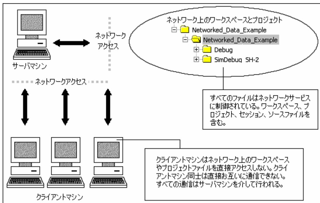
ネットワーク機能によってユーザはファイルへのアクセス権を与えられます。これによって、プロジェクトアドミニストレータから書き込みを許可されたユーザのみが、プロジェクトやソースファイルを変更できるようになります。アドミニストレータは、各ユーザの書き込み権を、プロジェクトの各自のエリアに制限して、他のエリアを読み出し専用にできます。こうして、各ユーザによるプロジェクトの他の部分への競合や破壊を未然に防ぎます。これらの制限は異なるレベルに設定できます。
