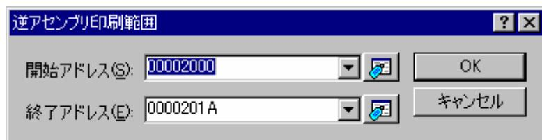
印刷する開始アドレスと終了アドレスを指定してください。[OK]ボタンをクリックすると、標準のプリントフォーマットを選択するダイアログボックスが開きます。ここで、使用するプリンタとページ設定のオプションを選択できます。[印刷]ボタンをクリックしてください。
