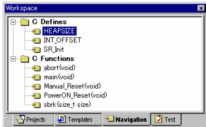
プロジェクトのファイルの中のテキスト部分へジャンプできます。[Navigation]タブに実際に表示される内容は、現在、何がインストールされているかによって異なります。上の図に例えばANSI規格 のCマクロ名定義 ( C Defines ) 、およびC関数一覧 ( C Functions ) を示します。ナビゲーションの詳細については「12. ナビゲーション機能」を参照してください。
