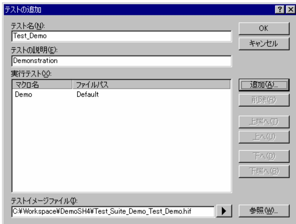
テストを選択し[変更]ボタンをクリックすると、選択したテストについて現在定義している詳細を変更できます。これらの詳細は、[テストの追加]で使用したダイアログボックスにも表示します。[削除]ボタンをクリックすると、テストを削除します。[テストの追加]ダイアログボックスでは、後で実行するためのテストを設定できます。詳細は「テストスイートにテストを追加する」で説明します。
