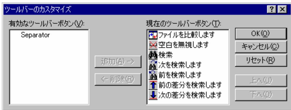
このダイアログボックスでは、表示するボタンを選択したり、ボタンの表示順序を変更できます。[有効なツールバー ボタン]は、ツールバーに現在表示されていないボタンをすべて表示します。[現在のツールバー ボタン]は、ツールバーに現在表示されているボタンをすべて表示します。
