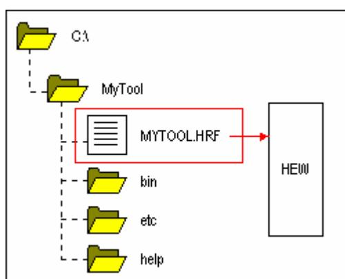
High-performance Embedded Workshopでツールを使うには、まず登録が必要です。[ツールアドミニストレーション]ダイアログボックスは現在登録されているツールを表示します。このダイアログボックスを開くには、ワークスペースがすべて閉じていることを確認して[ツール -> アドミニストレーション]を選択してください。ワークスペースを開いた状態で[ツールアドミニストレーション]ダイアログボックスをアクセスすると、ダイアログが開きますが変更はできません。High-performance Embedded Workshopがデフォルトでインストー
