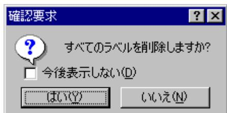
[OK]ボタンを押すと、すべてのラベルを High-performance Embedded Workshopのシンボルテーブルから削除し、リスト表示もクリアします。メッセージボックスの表示が不要のときは、[今後表示しない]チェックボックスをオンにしてください。
