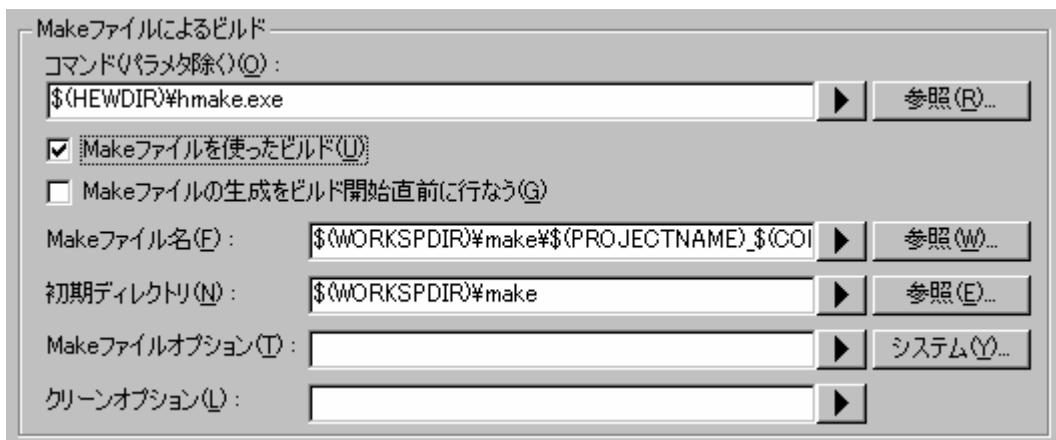
5. [コマンド (パラメタ除く)]エディットボックスにMakeツールを入力してください。デフォルトは、hmake（\$(HEWDIR)\hmake.exe）です。
