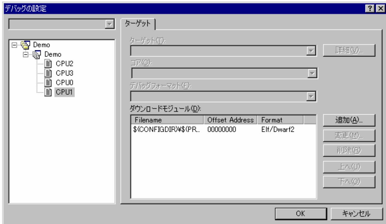
同期デバッグ時、[デバッグの設定]ダイアログボックスの機能が変わります。通常デバッグ時に使用可能なオプションを全部設定することはできず、セッションごとに設定するDownload modulesのみが変更できます。ダイアログボックスの左側で[Multiple]を使用して複数のセッションの設定を同時に変更することが可能です。これにより、同期ダウンロードの準備が整った複数のセッションに同じモジュールを容易に追加できます。ダウンロードモジュールを選択し、[変更]ボタンをクリックすると、[ダウンロードモジュール]ダイアログボックスが開きます。このダイアログで[デバッグ情報のみのダウンロード]を設定することができます。マルチコアデバッグですべてのコアが同じメモリ領域を共有している場合、メモリイメージは1つのセッションで一度だけダウンロードし、他のセッションではデバッグ情報だけダウンロードすることを推奨します。ダイアログボックスのボタンの機能性は通常デバッグ時と同じです。詳細については、「17.1.4.3 デバッグの設定を変更する」を参照してください。
