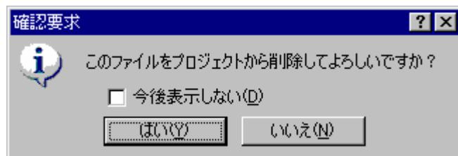
確認要求のダイアログボックスを表示しない場合、[今後表示しない]チェックボックスをオンにしてください。確認要求のダイアログボックスを再び表示するには、[基本設定 -> オプション]を選択し[オプション]ダイアログボックスを開きます。[確認]タブの[プロジェクトからファイルを削除]チェックボックスをオンにしてください。このチェックボックスのデフォルトはオンです。
