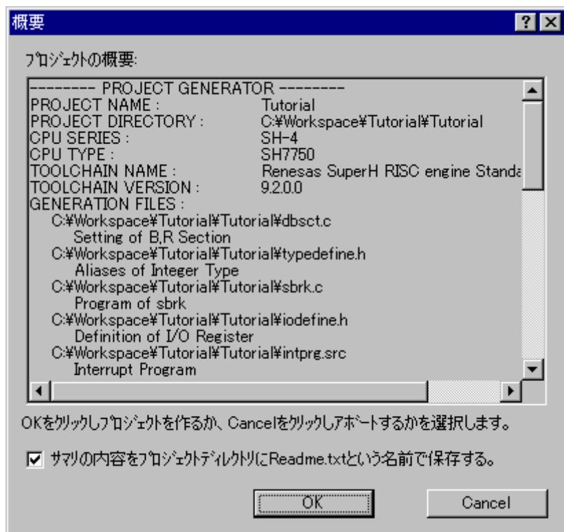
10. プロジェクトジェネレータは、生成するプロジェクトに関する情報を[概要]ダイアログボックスに表示するので、確認後[OK]ボタンをクリックしてください。[Cancel]ボタンをクリックすると[新規プロジェクト]ウィザードに戻ります。
