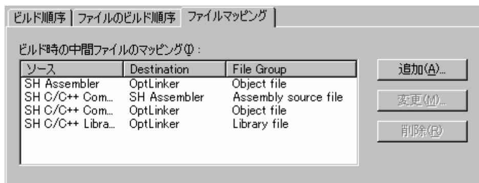
ファイルマッピングでは、あるフェーズ(出力元フェーズという)で作成したある種類の出力ファイル(中間ファイル)を、他のフェーズ(出力先フェーズという)に渡すように指定します。プロジェクトファイルに加えて中間ファイルも渡します。
