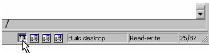
この例では、選択されたデスクトップ番号は"1"で、"Build"という名前が付いています。ボタンの右側のボックスに"Build desktop"と表示しています。別のデスクトップボタンをクリックするとボタンの右側のボックスの表示も切り替わります。一度クリックすると、新しい構成の形式でウィンドウを読み込みます。
