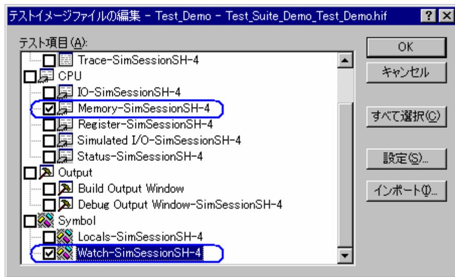
4. 配列のアドレスのメモリ内容をテストイメージファイルに保存します。[テストイメージファイルの編集]ダイアログボックスで、[テスト項目]の[CPU]下の[Memory-xxxxxx]をダブルクリックし、[テスト設定-メモリ]ダイアログボックスを開きます。
