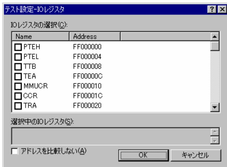
1. テストイメージファイルに保存するI/Oレジスタを指定するには、[IOレジスタの選択]リストのI/Oレジスタ名のチェックボックスをオンにします。チェックボックスのデフォルトはオフです。選択したI/Oレジスタは[選択中のIOレジスタ]に表示します。
