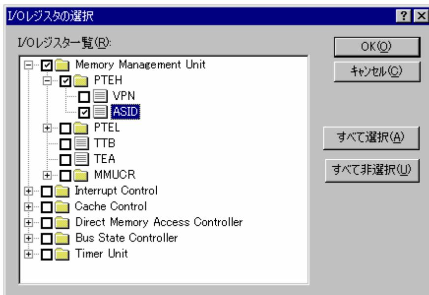
3. [I/Oレジスター覧]の各項目にはチェックボックスを表示します。チェックボックスはデフォルトでオフです。'+'が表示されている項目は、'+'のクリックによって展開できます。また、'-'が表示されている項目は、'-'のクリックによって折りたたむことができます。'+'または'-'が表示されている項目のチェックボックスをオンにすると、その項目の要素のチェックボックスはすべてオンになります。オフにすると、その項目の要素のチェックボックスはすべてオフになります。表示するI/Oレジスタのチェックボックスをオンにしてください。
