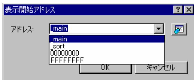
上記のダイアログボックスに、ラベルを選択するリストも表示します。High-performance Embedded Workshop のアプリケーション全体を通して、アドレスエディットフィールドに入力された過去20件を、このリストに保存します。同じラベルを何度も入力する場合、この最近使用した[アドレス]のドロップダウンリストを使用すれば、より効率的に入力できます。入力を評価するアドレスエディットフィールドの場合にこの操作が可能です。
