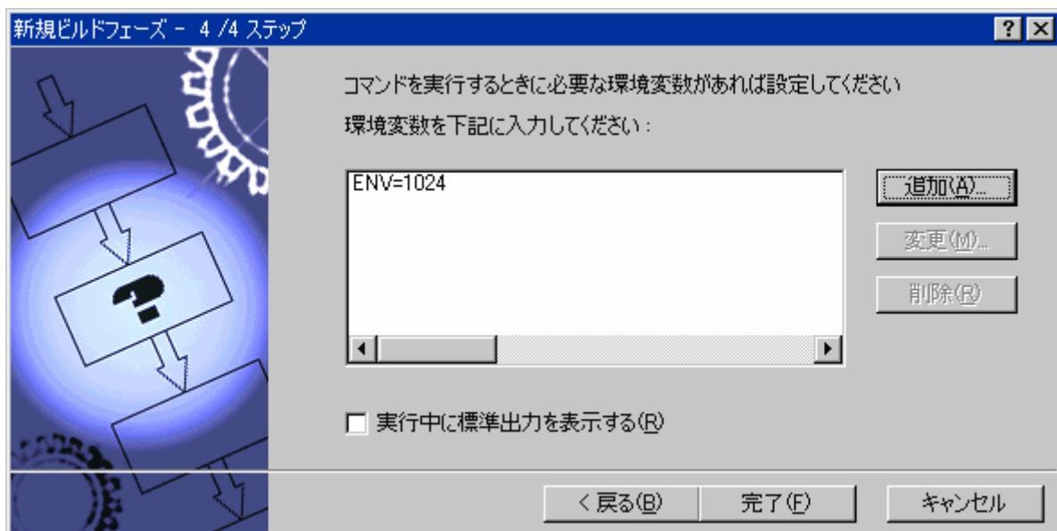
新しい環境変数を追加するには、[追加]ボタンをクリックしてください。[環境変数]ダイアログボックスを開きます。新しい環境変数を追加するには[変数]に環境変数名を入力して[値]に環境変数の値を入力して[OK]ボタンをクリックします。環境変数を変更するには、ステップ4のダイアログボックスのリストから環境変数を選んで、[変更]ボタンをクリックします。[変数]と[値]を変更して[OK]ボタンをクリックすると、リストに変更した変数を追加します。環境変数を削除するには、ステップ4のダイアログボックスのリストから削除する環境変数を選んで、[削除]ボタンをクリックします。
