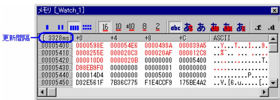
ユーザプログラム実行中の自動更新間隔を設定するには、メモリウィンドウのポップアップメニューから[更新間隔]を選択します。機能がサポートされている場合のみ表示されます。
