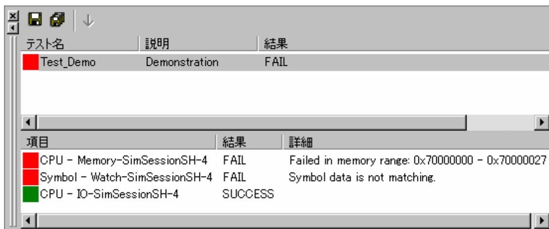
テストブラウザ上側のペインには、前回実行されたすべてのテストを表示します。テスト名の左にある緑のアイコンは、テストが成功したことを示します。赤のアイコンは、テストが失敗したことを示します。
