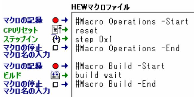
アウトプットウィンドウの[Macro]タブには現在のマクロの記録状況を出力します。上の図の「Build」マクロは下記のように出力します。
