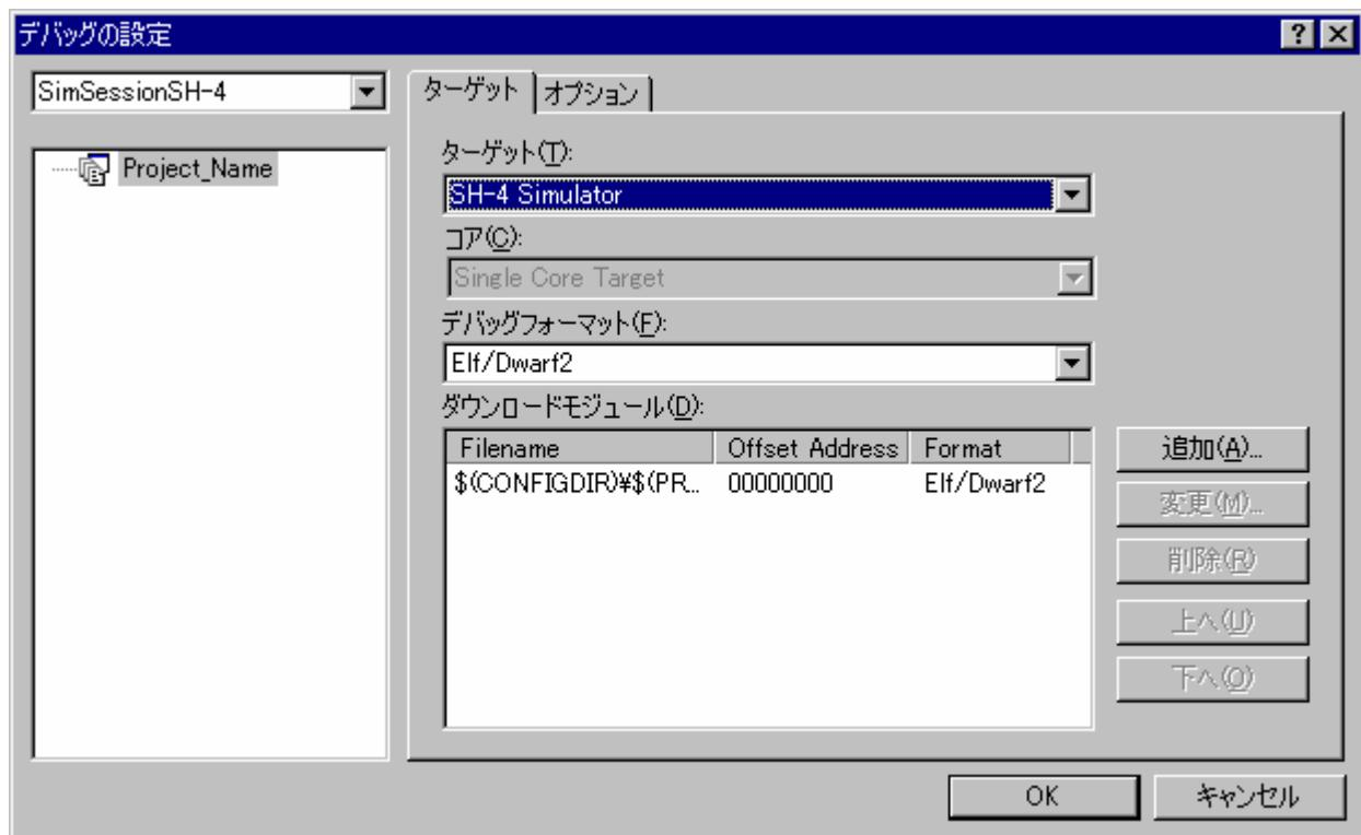
[デバッグの設定]ダイアログボックスの[ターゲット]タブでは、[ターゲット]、[コア]、[デバッグフォーマット]、および[ダウンロードモジュール]を選択できます。ただし、[コア]は、同期デバッグ機能を使用している場合に選択できます。
