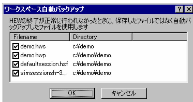
ファイルを回復するには、回復したいファイルの名前の横にあるチェックボックスをオンにし、[OK]ボタンをクリックしてください。[キャンセル]ボタンをクリックすると、自動バックアップファイルを削除し、元のファイルからロードを行います。
