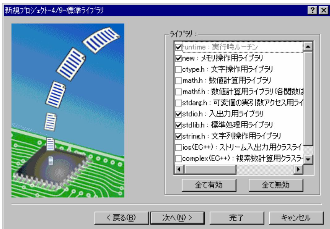
4. ステップ4ではC/C++コンパイラで使用する標準ライブラリの構成を設定します。
