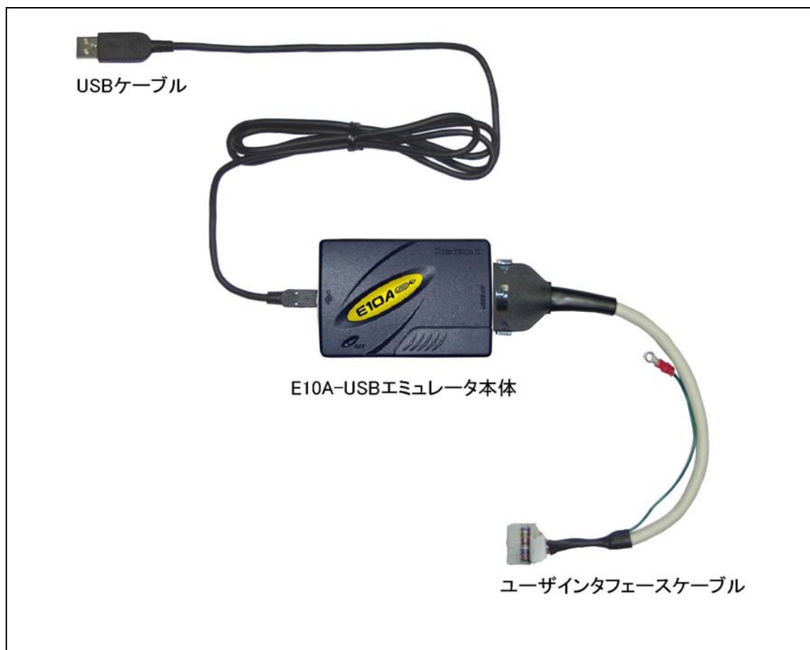
図 3.2 E10A-USB エミュレータのハードウェア構成 (14ピンケーブル時)
