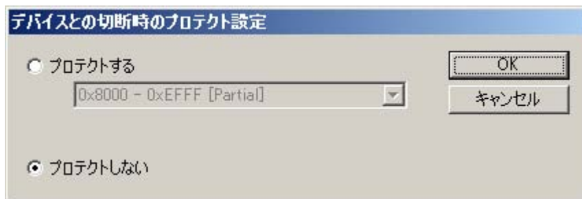
図 14-3 接続解除時のプロテクトの選択
