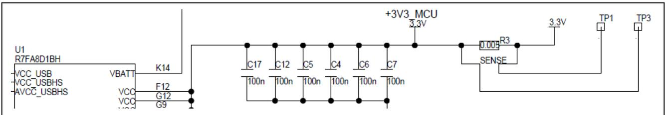
図 29. RA +3.3 V 電流測定回路
