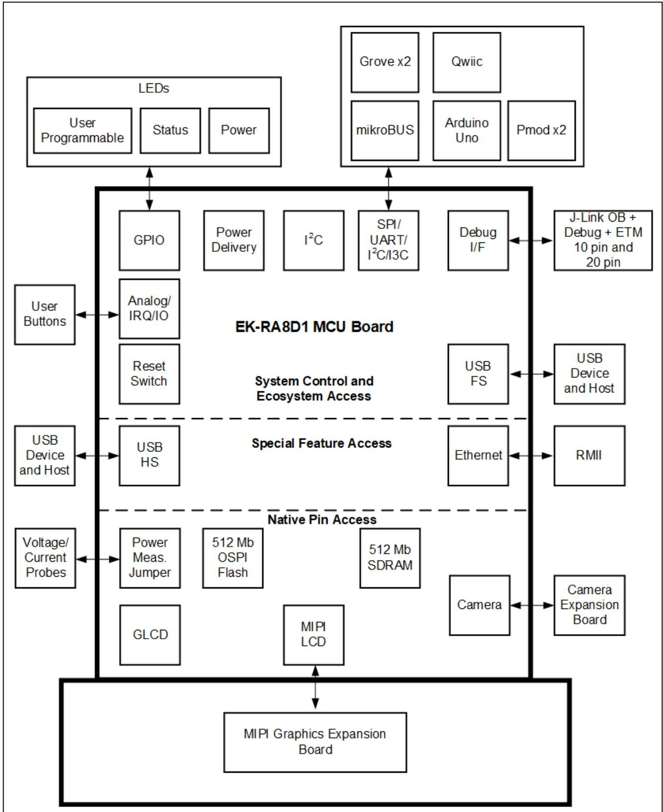
図 5. EK-RA8D1 ボードのブロック図
