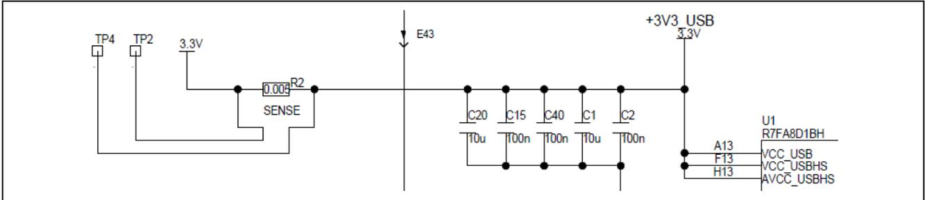
図 28. RA USB 電流測定回路
