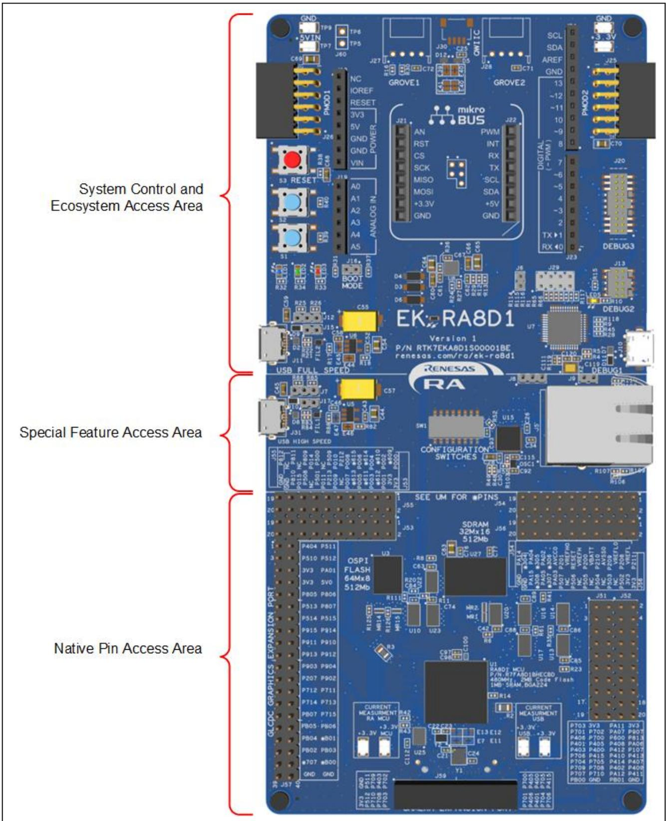
図 4. EK-RA8D1 ボード機能エリアの定義
