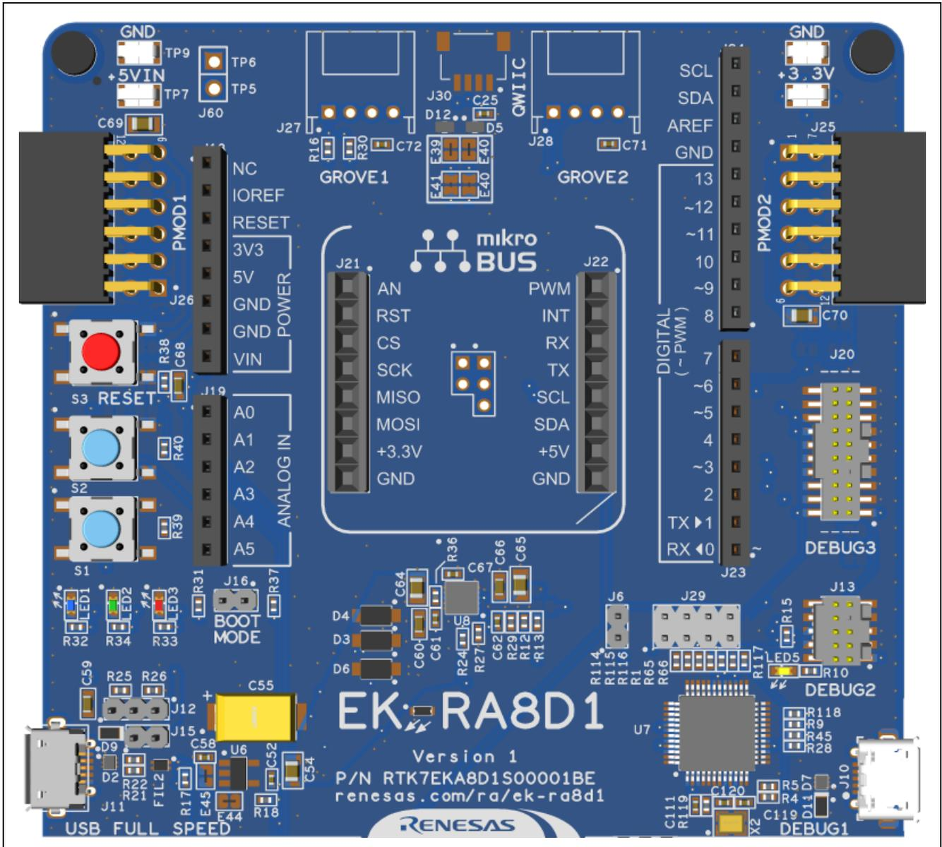
図 7. System Control and Ecosystem Access エリア
