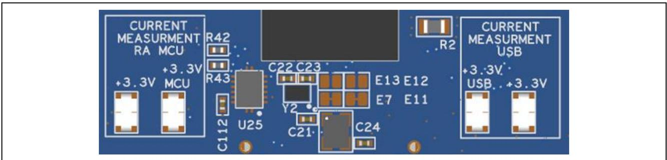
図 30. RA MCU と USB 電流測定
