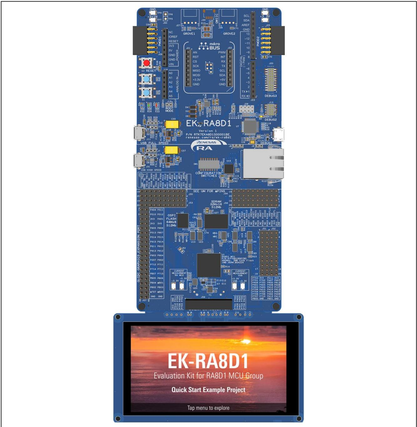
図 31. MIPI グラフィックス拡張ボードを接続した EK-RA8D1 ボード
