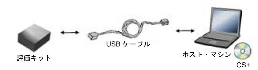
図 2.4 ホスト・マシンとデバッグ・ツールとの接続例【EZ Emulator】
