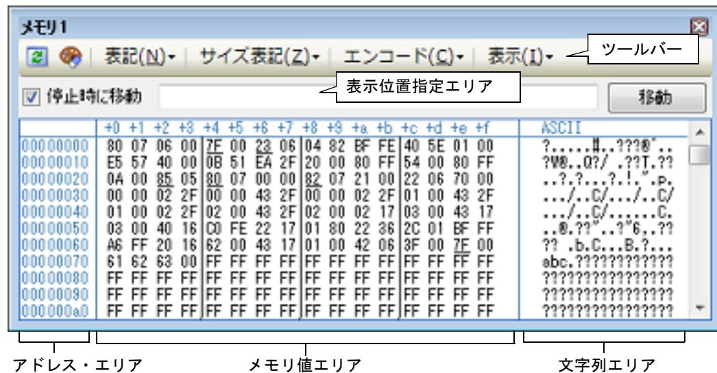
**備考** ツールバーの [表示] → ボタンをクリックすることによりオーブンする[スクロール範囲設定ダイアログ](#)により、このパネルの垂直スクロール・バーのスクロール範囲（開始アドレス／終了アドレス）を設定することができます。
