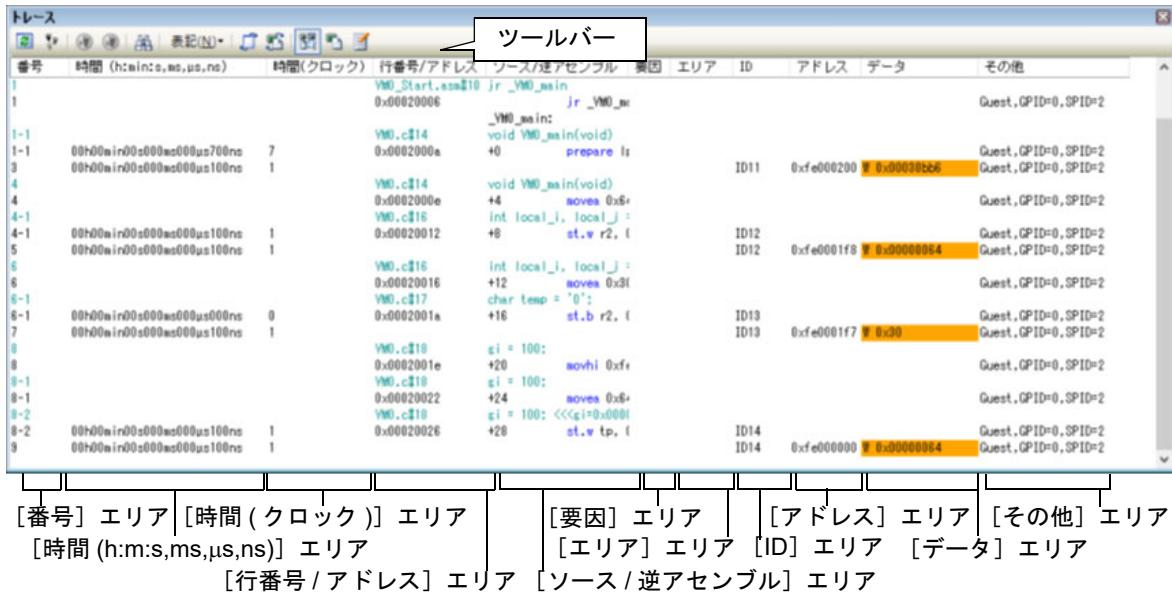
図 2.71 トレース・データの表示（トレース パネル【シミュレータ】）
