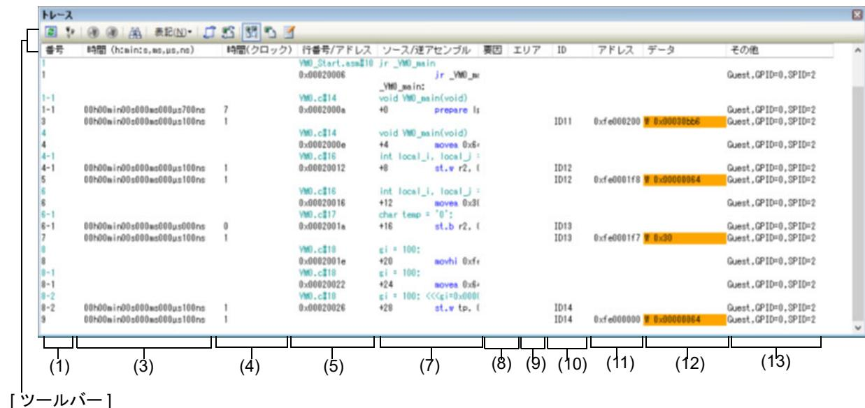
図 A.17 トレース パネル【シミュレータ】
