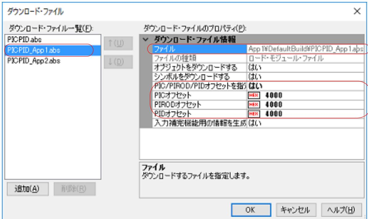
[PIC オフセット]、[PIROD オフセット] および [PID オフセット] の値を変更したのち、ロード・モジュールのダウンロードを実行すると、以下の図のように、コード・セクションのアドレス、および、外部変数または静的変数のアドレスの配置が変更されます。
