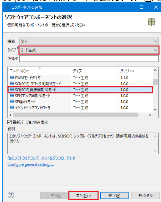
図 4-23: SCI(SCIF)調歩同期式モード選択
