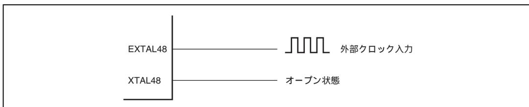
図 21.8 外部 48MHz クロックの接続例
