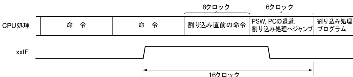
図15-12 割り込み要求の受け付けタイミング（最大時間）
