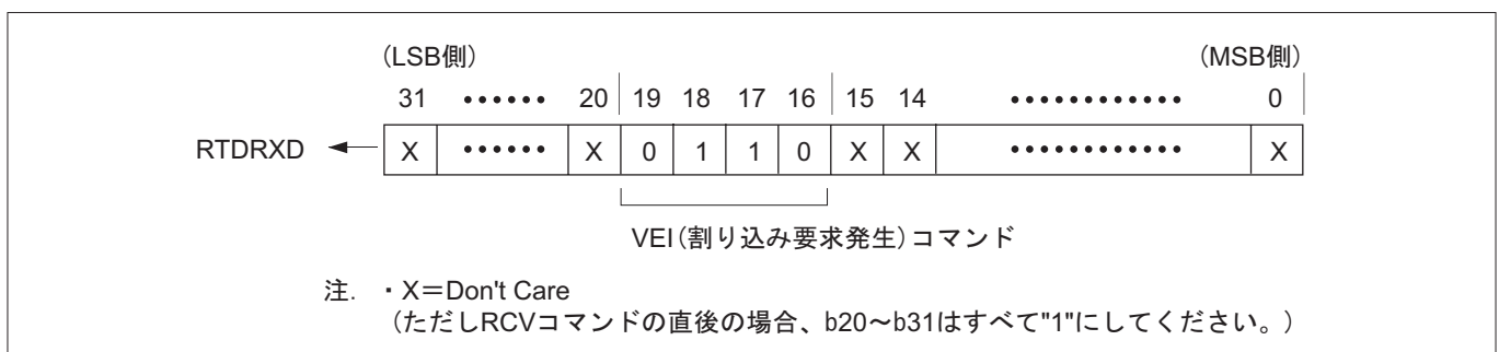
図15.4.8 VEI( 割り込み要求 )コマンドデータフォーマット
