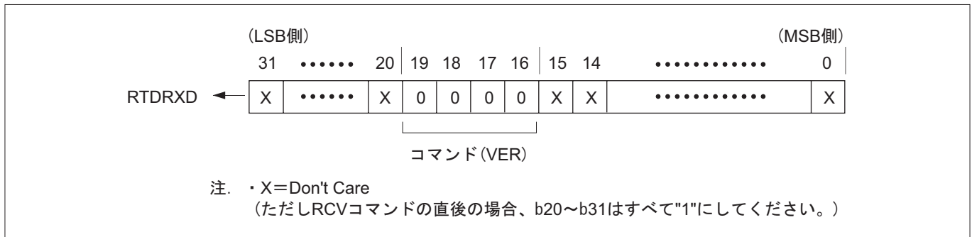
図15.4.6 VER( 継続モニタ )コマンドデータフォーマット
