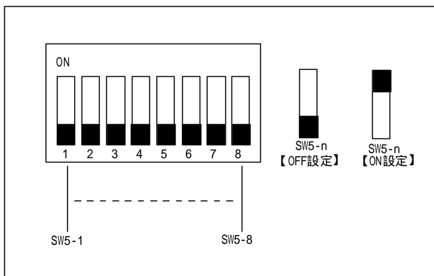
図 3.2 8bit ディップスイッチの設定
