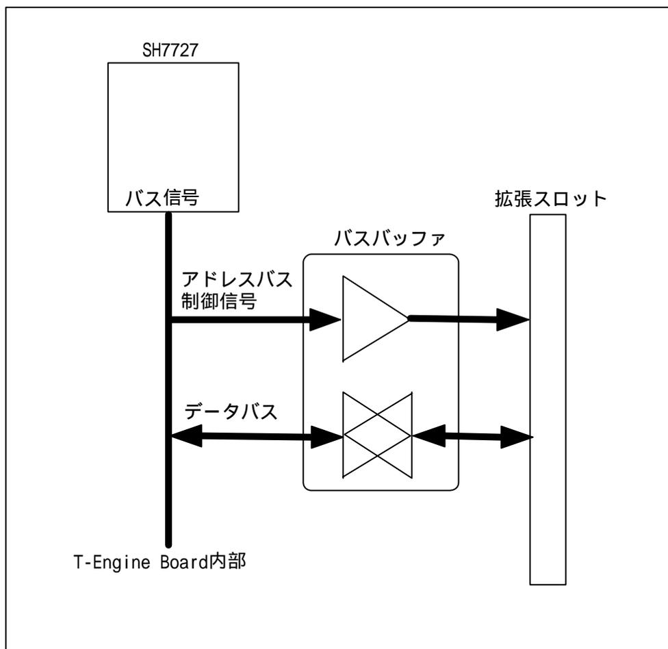
図9.4 拡張スロットのバスバッファ構成
