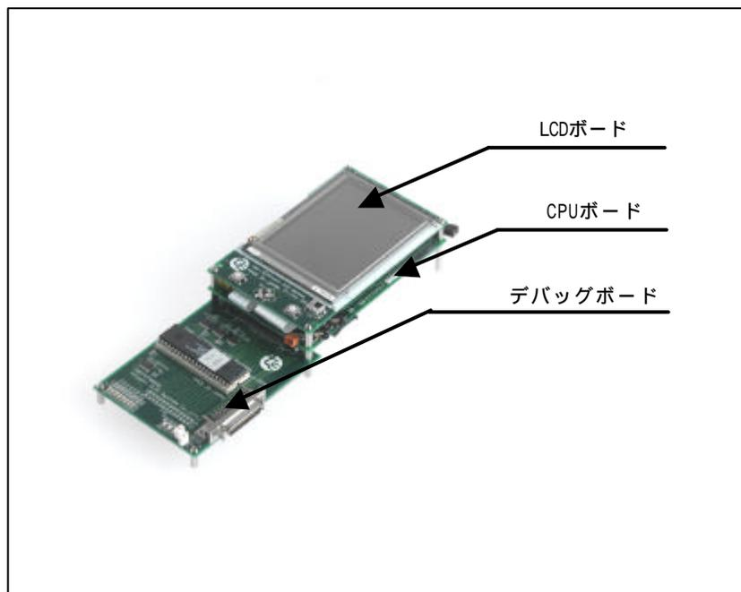
図1.2 T-Engineボードの外観
