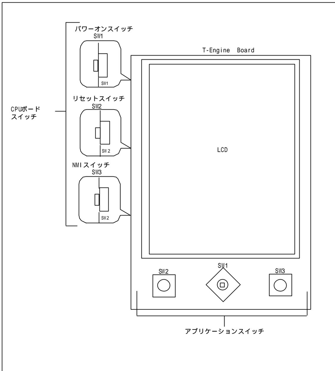
図 6.12 T-Engine ボードのスイッチ
