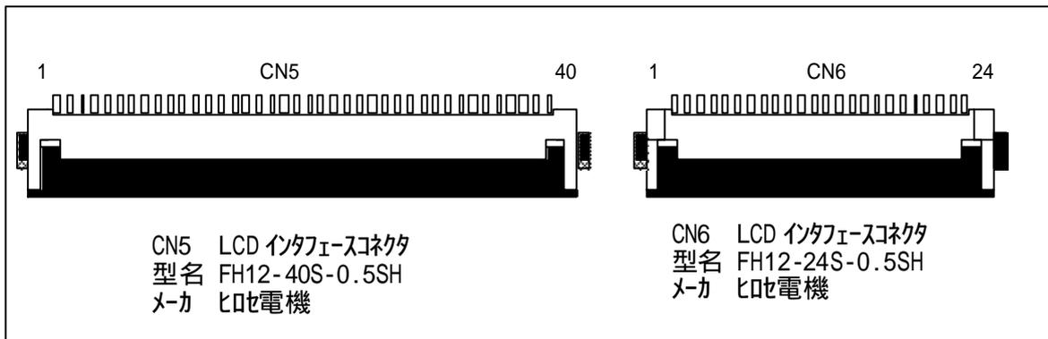
図 5.7 LCD インタフェースコネクタ (CN5、CN6)のピン配置
