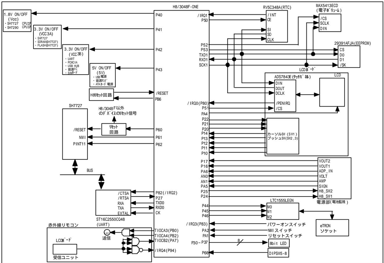
図 6.1 電源コントローラブロック図
