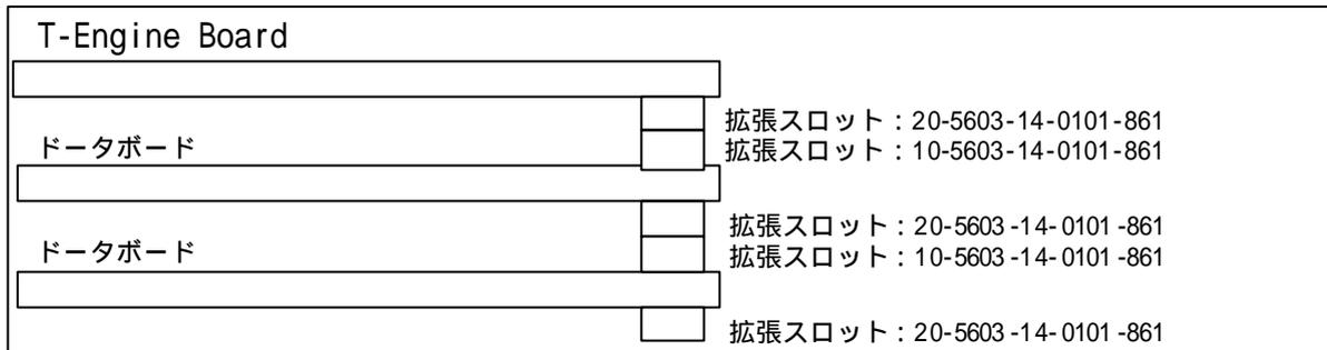
図 9.2 ドータボードのスタック構成
