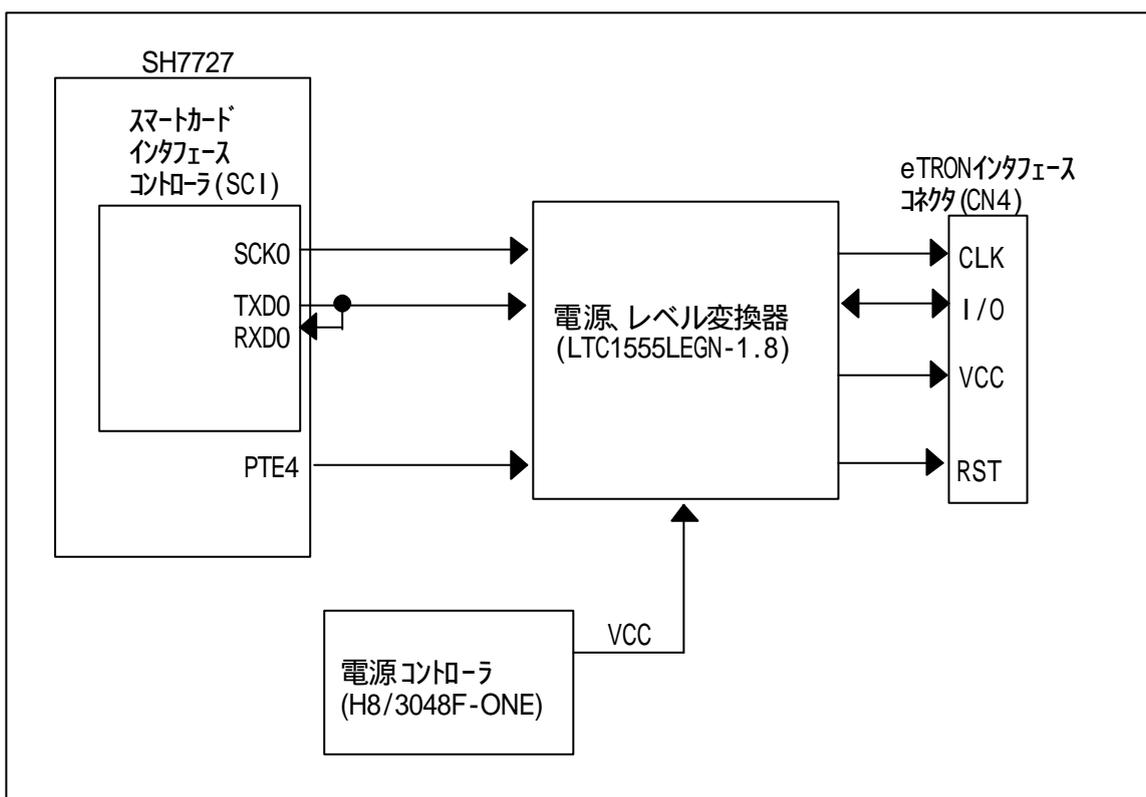
図 5.11 eTRON インタフェース制御ブロック
