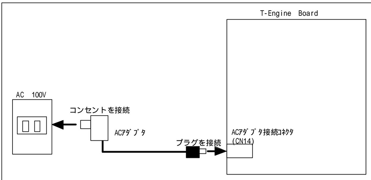
図 2.3 AC アダプタの接続方法
