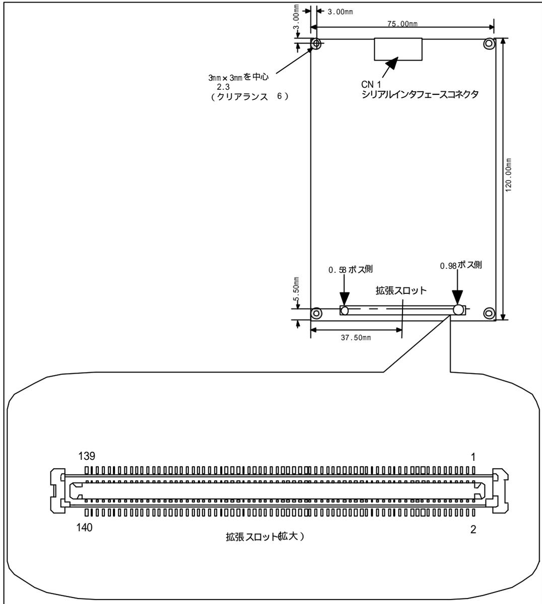
図 8.1 拡張スロットの配置図
