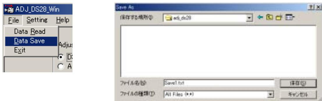
3. その後、プログラムはカメラデモシステムMV-DS28 から全データの受信を行い、Save Asダイアログで指定されたフォルダに指定されたファイル名でデータファイルを作成します。
