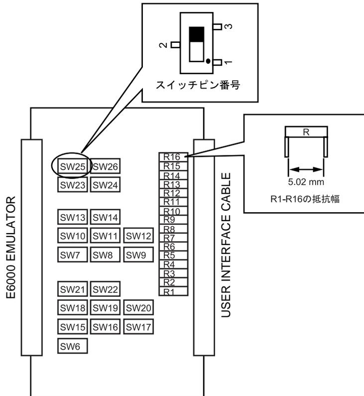
図 3.2 端子設定スイッチおよび抵抗
