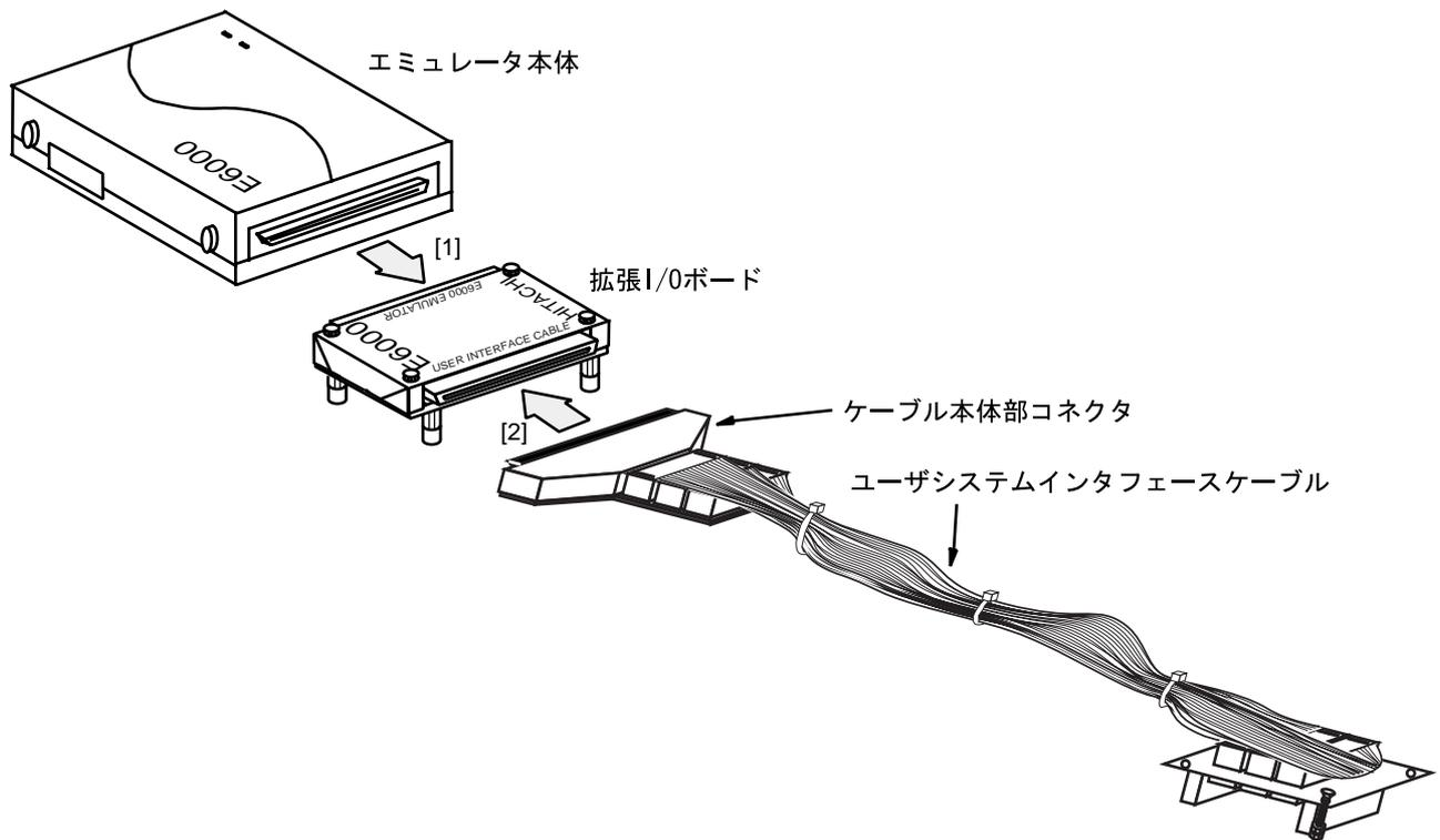
図 2.1 エミュレータ本体とユーザーシステムインタフェースケーブルへの接続
